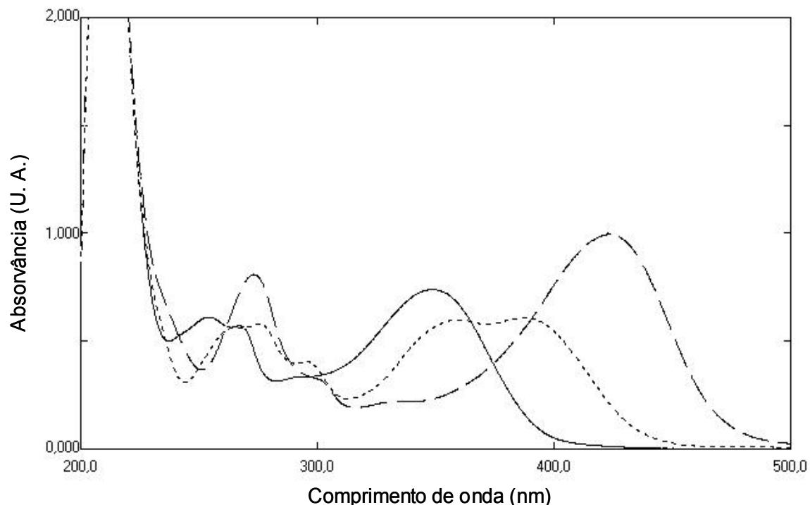
Figura A3. Espectro na região do UV-visível para solução de luteolina em metanol (—), após complexação com  $\text{AlCl}_3$  (---) e subsequente hidrólise com  $\text{HCl}$  (...)
