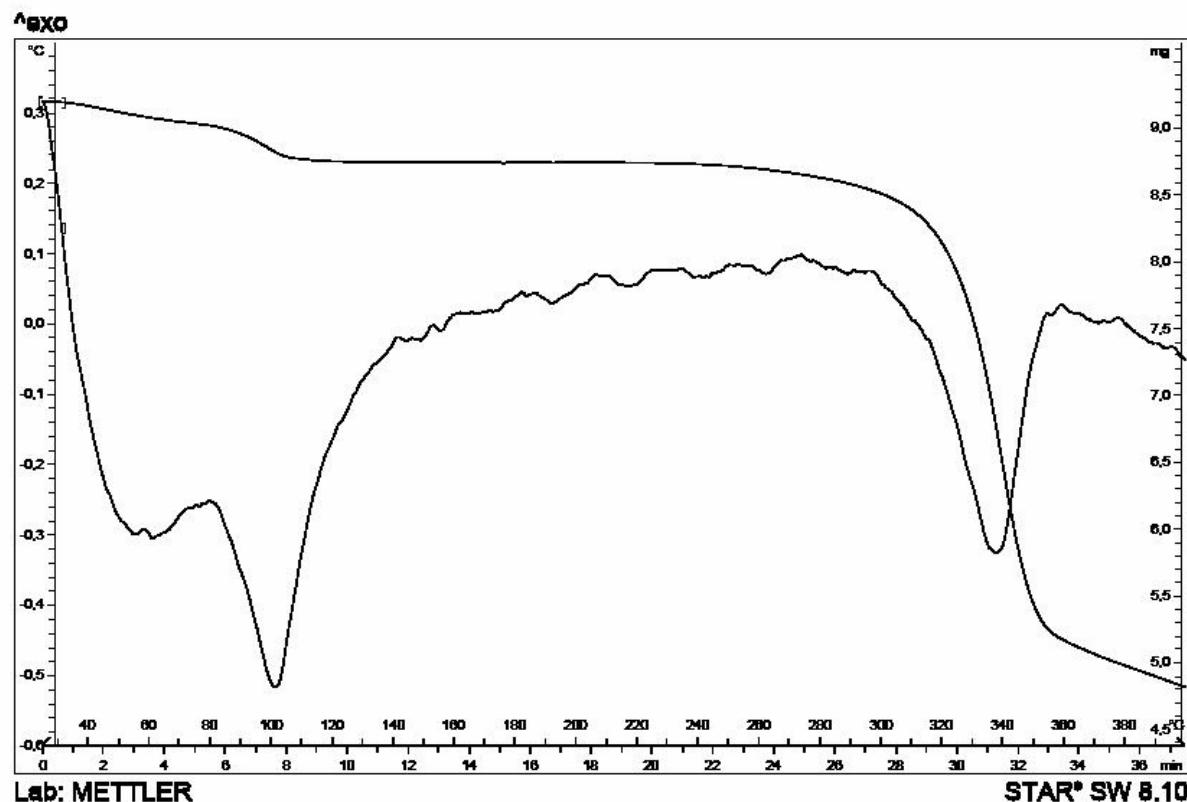
Figura 35. Curva de aquecimento obtida por DTA e curva termogravimétrica para a mistura binária equiponderal entre a miricetina e a celulose microcristalina
