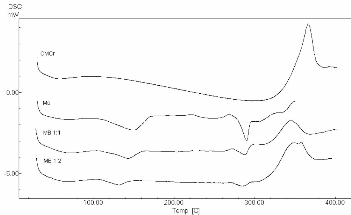
Figura 40. Curvas de aquecimento obtidas por DSC para a morina (Mo) e a celulose microcristalina (CMCr) e para suas misturas binárias (MB) nas proporções ponderais 1:1 e 1:2
