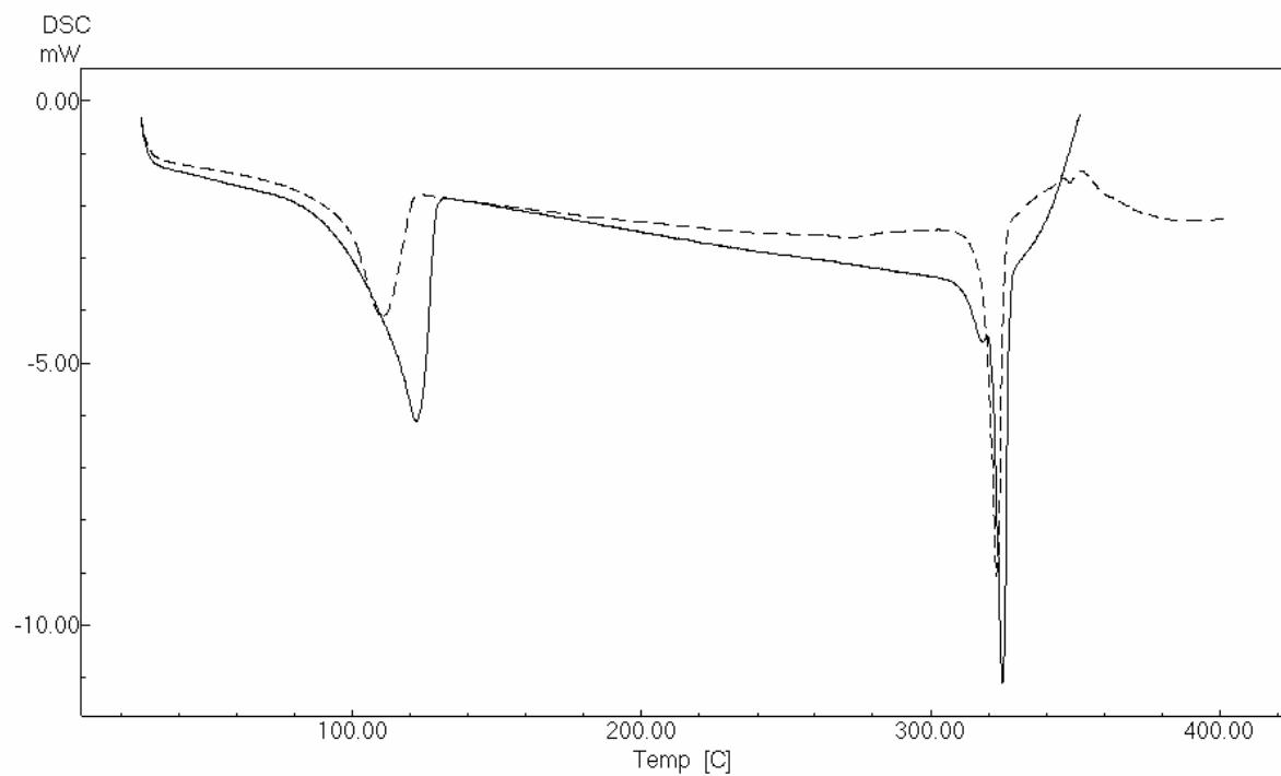
Figura 47. Curvas de aquecimento obtidas por DSC para a queracetina amostra (--) e referência (-)
