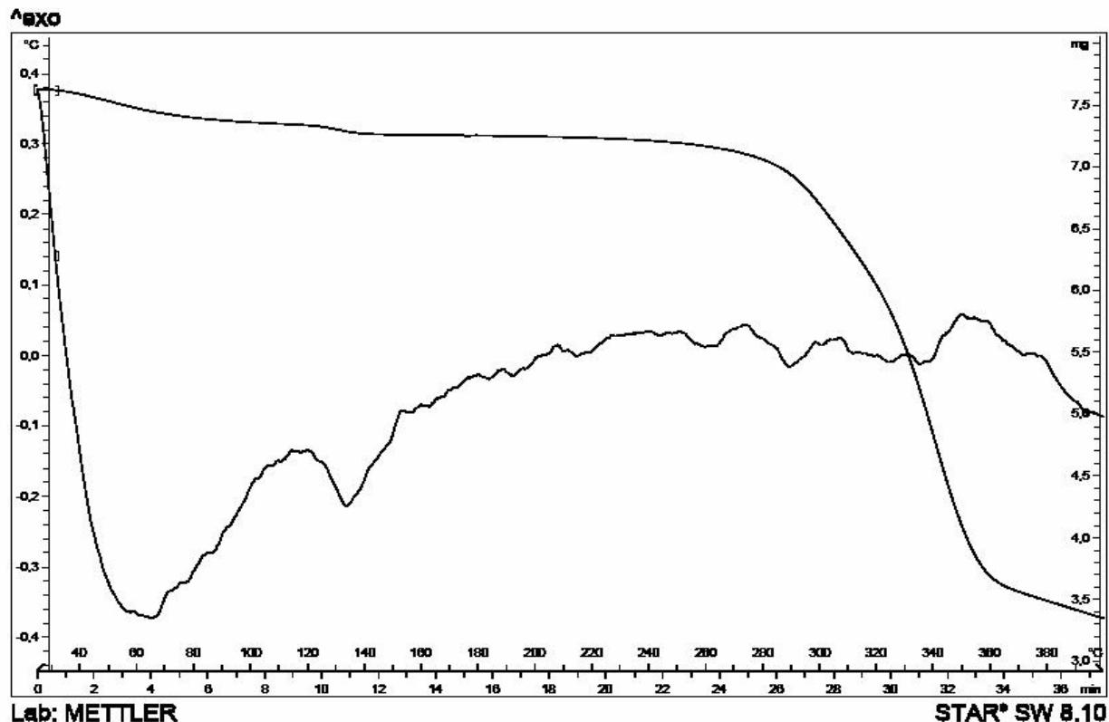
Figura 44. Curva de aquecimento obtida por DTA e curva termogravimétrica para a mistura binária na proporção ponderal de 1:2 entre a morina e a celulose microcristalina
