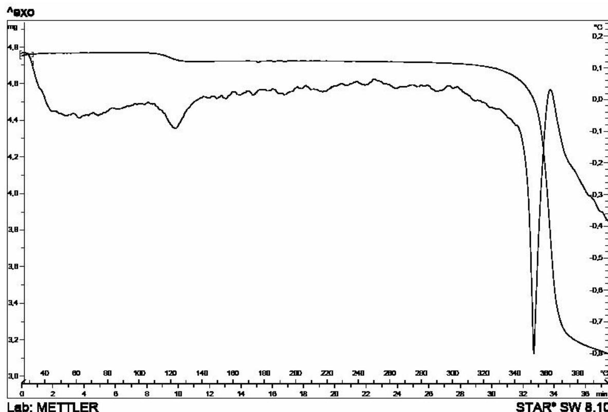
Figura 20. Curva de aquecimento obtida por DTA e curva termogravimétrica para a fisetina
