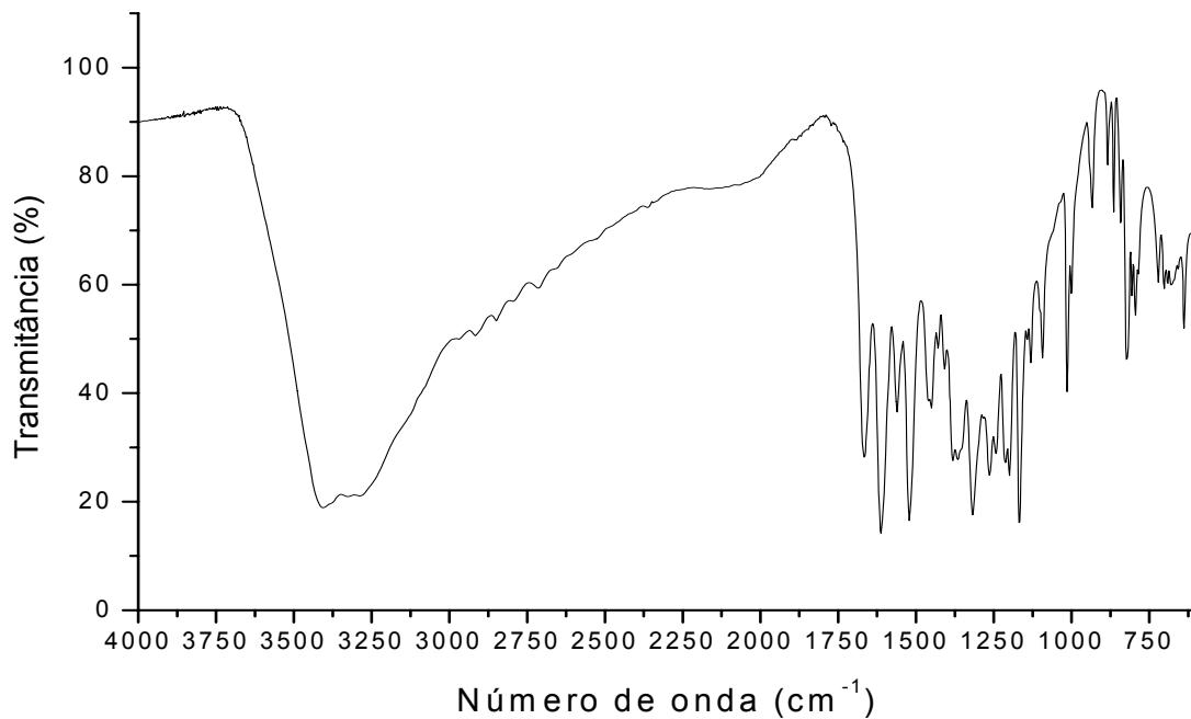
Figura 51. Espectro na região do infravermelho da mistura binária equiponderal de quercetina com celulose microcristalina
