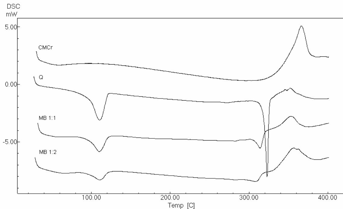
Figura 49. Curvas de aquecimento obtidas por DSC para a quercetina (Q) e a celulose microcristalina (CMCr) e para suas misturas binárias (MB) nas proporções ponderais 1:1 e 1:2
