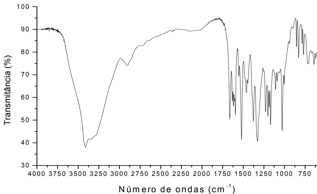
Figura 38. Espectro na região do infravermelho da mistura binária entre a miricetina e a celulose microcristalina na proporção ponderal 1:2
