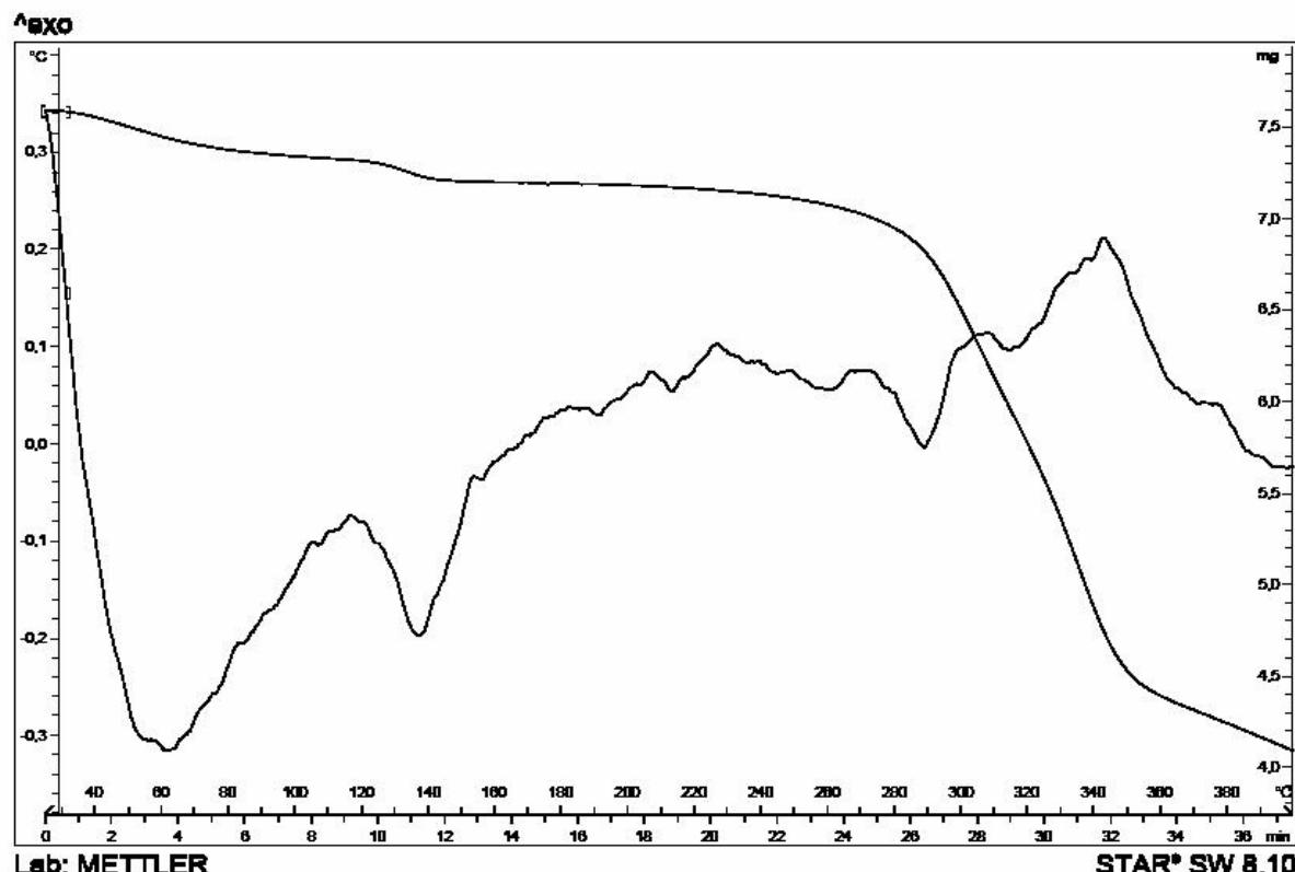
Figura 42. Curva de aquecimento obtida por DTA e curva termogravimétrica para a mistura binária equiponderal entre a morina e a celulose microcristalina
