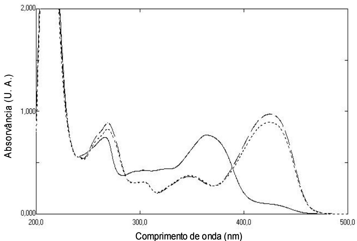
Figura A1. Espectro na região do UV-visível para a solução de canferol em metanol (—), após complexação com AlCl<sub>3</sub> (---) e subsequente hidrólise com HCl (...)
