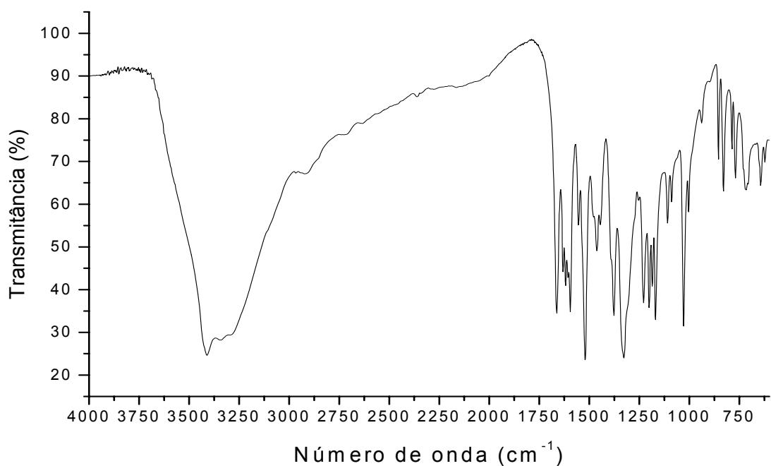
Figura 36. Espectro na região do infravermelho da mistura equiponderal binária da miricetina com a celulose microcristalina
