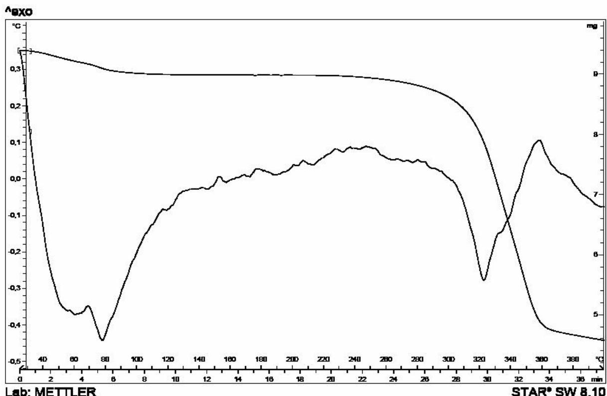
Figura 30. Curva de aquecimento obtida por DTA e curva termogravimétrica para a mistura binária na proporção ponderal de 1:2 entre a luteolina e a celulose microcristalina
