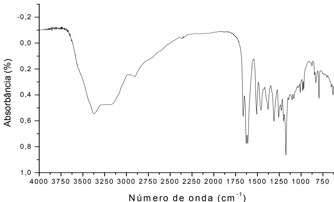
Figura 43. Espectro na região do infravermelho da mistura binária equiponderal da morina com a celulose microcristalina
