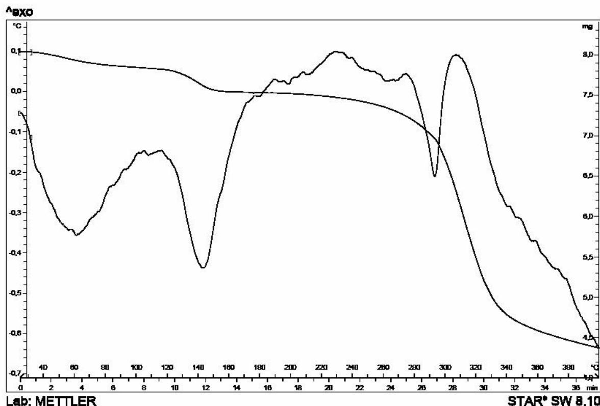
Figura 41. Curva de aquecimento obtida por DTA e curva termogravimétrica para a morina
