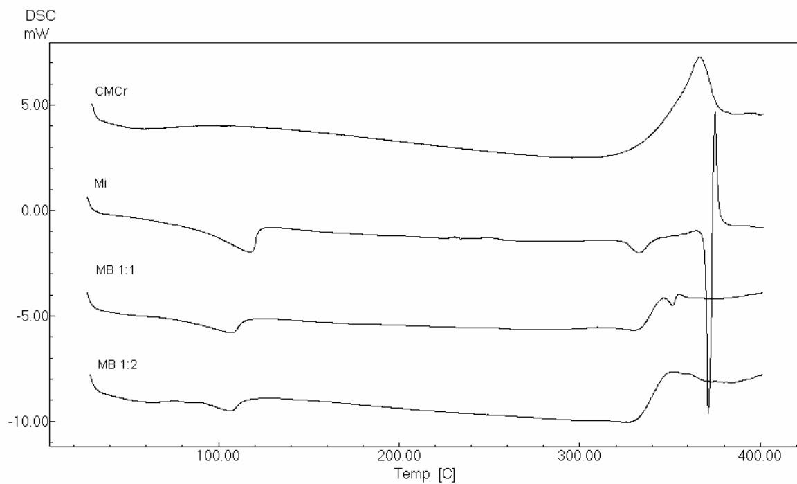
Figura 33. Curvas de aquecimento obtidas por DSC para a miricetina (Mi) e a celulose microcristalina (CMCr) e para suas misturas binárias (MB) nas proporções ponderais 1:1 e 1:2
