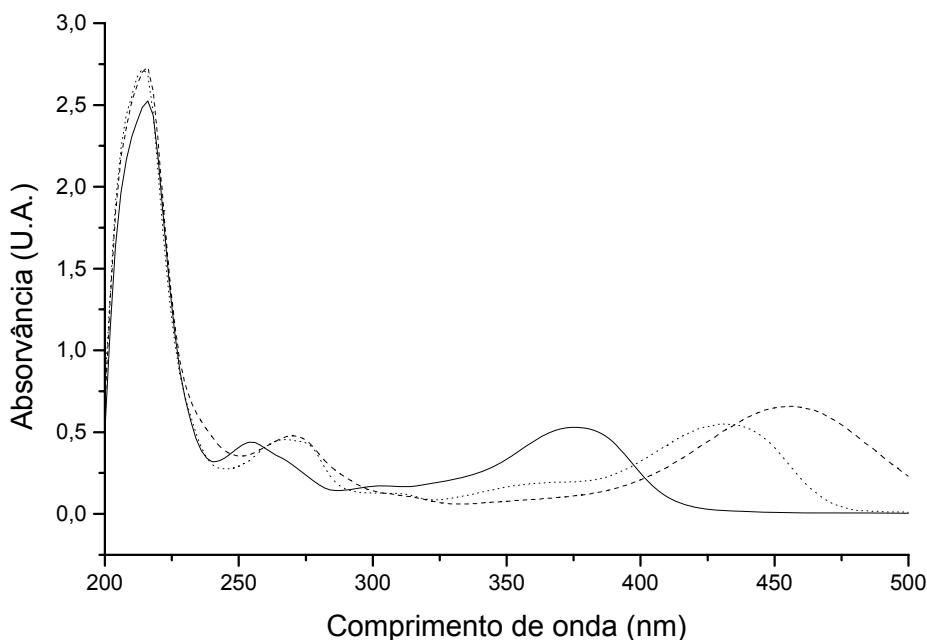
Figura A4. Espectro na região do UV-visível para a solução de miracetina em metanol (—), após complexação com  $\text{AlCl}_3$  (---) e subsequente hidrólise com  $\text{HCl}$  (...)
