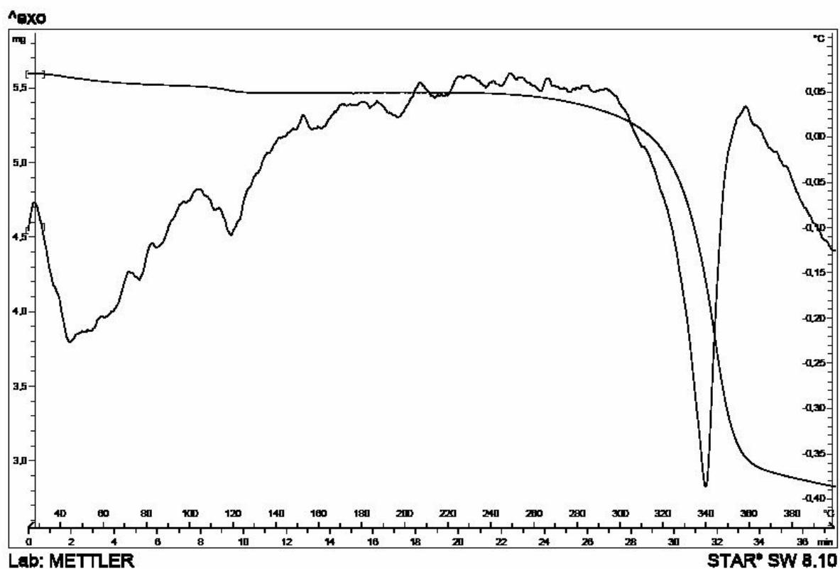
Figura 21. Curva de aquecimento obtida por DTA e curva termogravimétrica para a mistura binária equiponderal entre a fisetina e a celulose microcristalina
