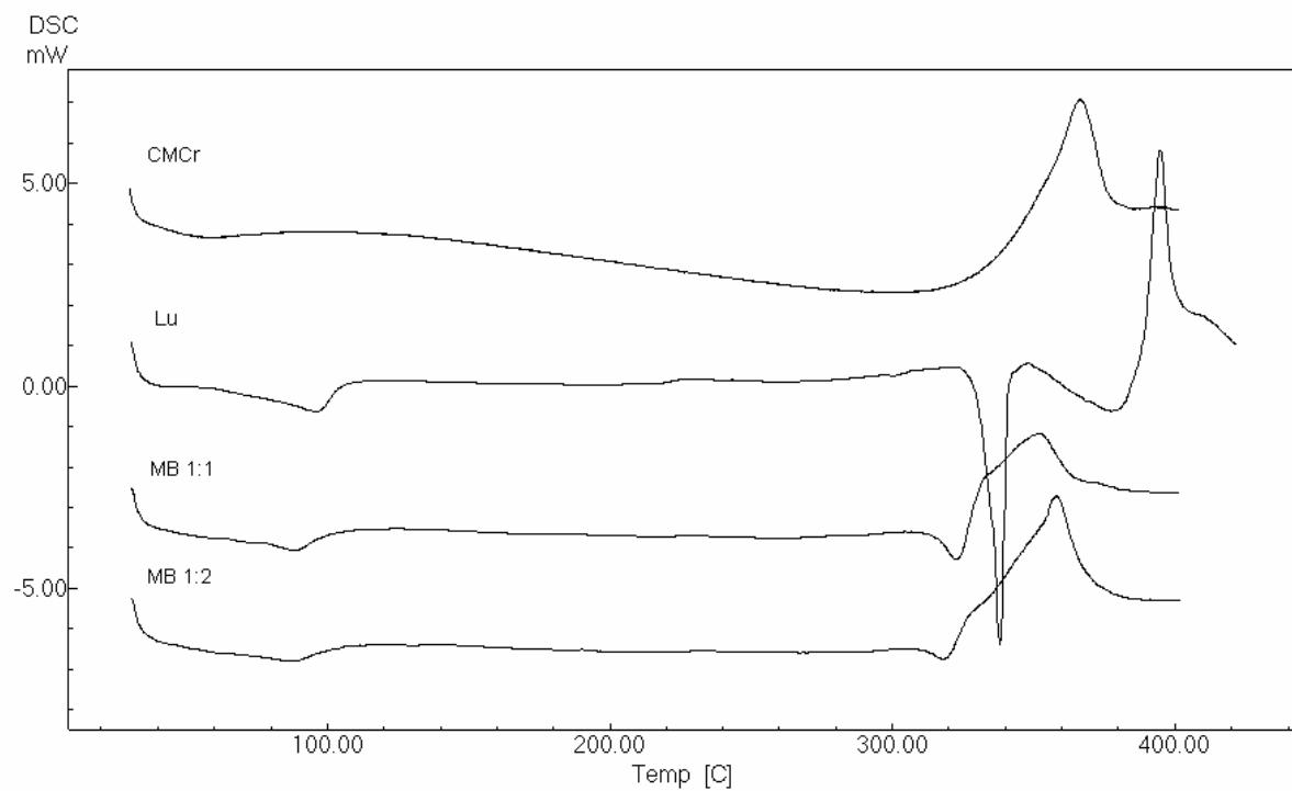
Figura 26. Curvas de aquecimento obtidas por DSC para a luteolina (Lu) e a celulose microcristalina (CMCr) e para suas misturas binárias nas proporções ponderais 1:1 e 1:2
