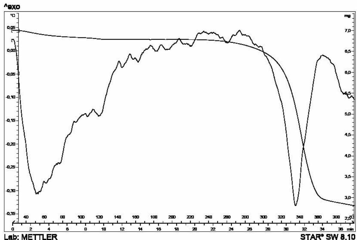
Figura 23. Curva de aquecimento obtida por DTA e curva termogravimétrica para a mistura binária na proporção ponderal de 1:2 entre a fisetina e a celulose microcristalina
