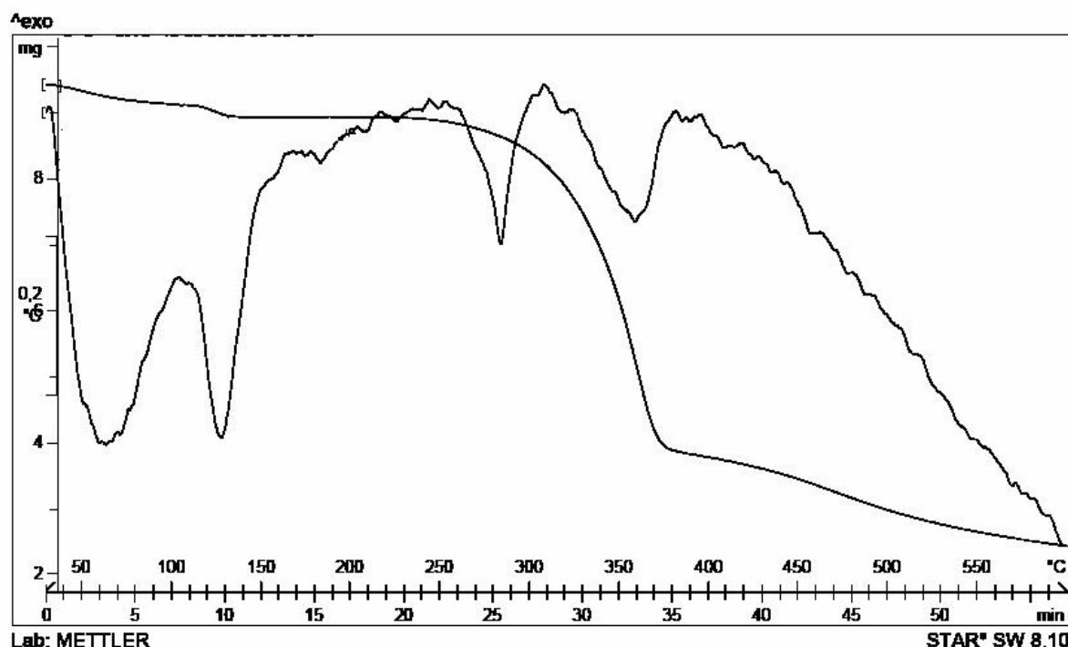
Figura 16. Curva de aquecimento obtida por DTA e curva termogravimétrica para a mistura binária na proporção ponderal de 1:2 entre o canferol e a celulose microcristalina
