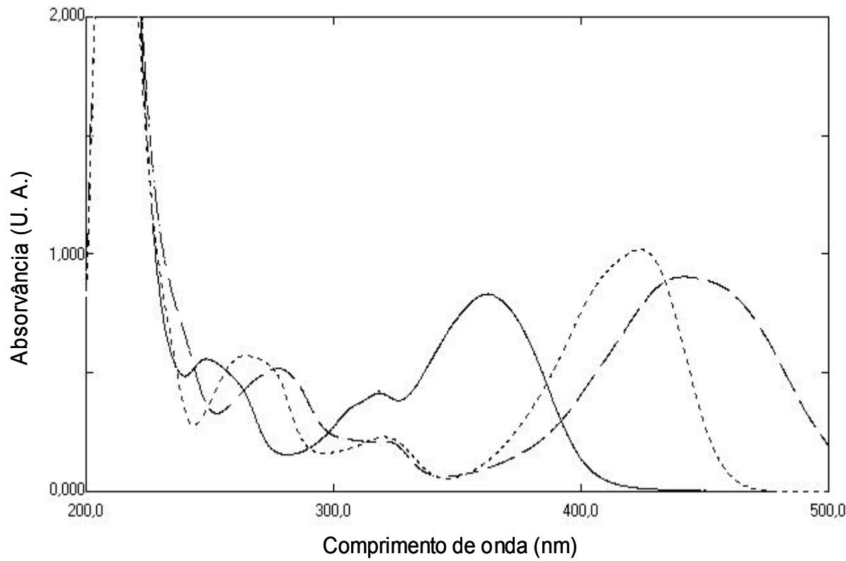
Figura A2. Espectro na região do UV-visível para a solução de fisetina em metanol (—), após complexação com AlCl<sub>3</sub> (---) e subsequente hidrólise com HCl (...)
