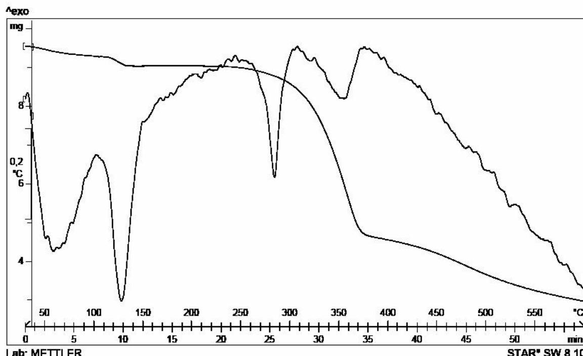
Figura 14. Curva de aquecimento obtida por DTA e curva termogravimétrica para a mistura binária equiponderal entre o canferol e a celulose microcristalina
