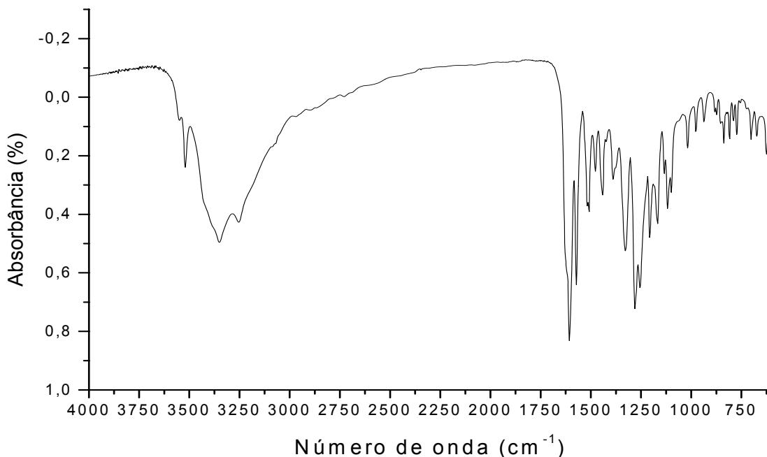
Figura 24. Espectro na região do infravermelho da mistura binária entre a fisetina e a celulose microcristalina na proporção ponderal 1:2
