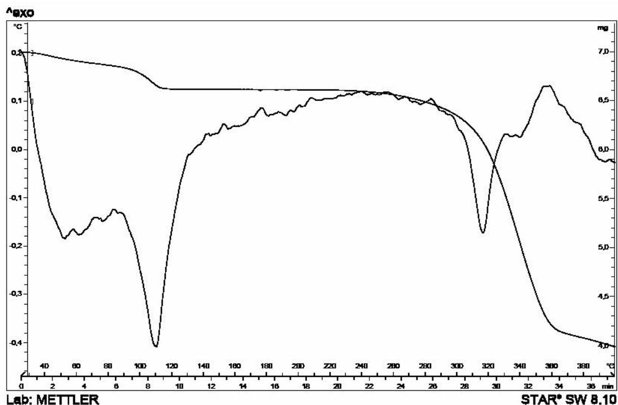
Figura 50. Curva de aquecimento obtida por DTA e curva termogravimétrica para a mistura binária equiponderal entre a quercetina e a celulose microcristalina
