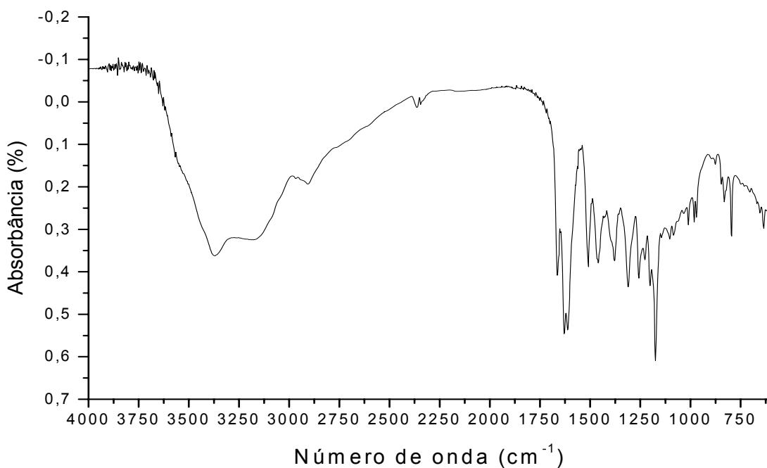
Figura 45. Espectro na região do infravermelho da mistura binária entre a morina e a celulose microcristalina na proporção ponderal 1:2
