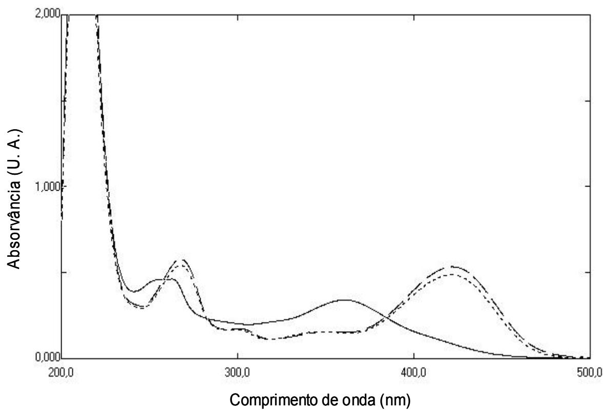
Figura A5. Espectro na região do UV-visível para a solução de morina em metanol (—), complexada com AlCl<sub>3</sub> (---) e após hidrólise com HCl (…)
