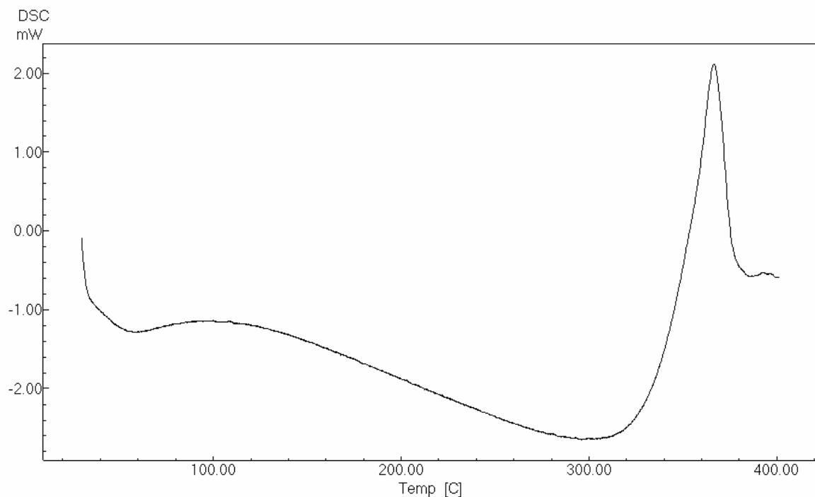
Figura 7. Curva de aquecimento obtida por DSC para a celulose microcristalina
