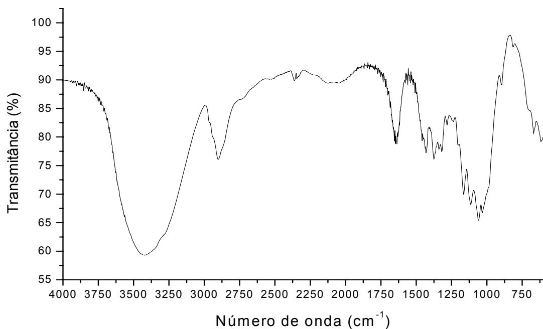
Figura 6. Espectro na região do infravermelho da celulose microcristalina
