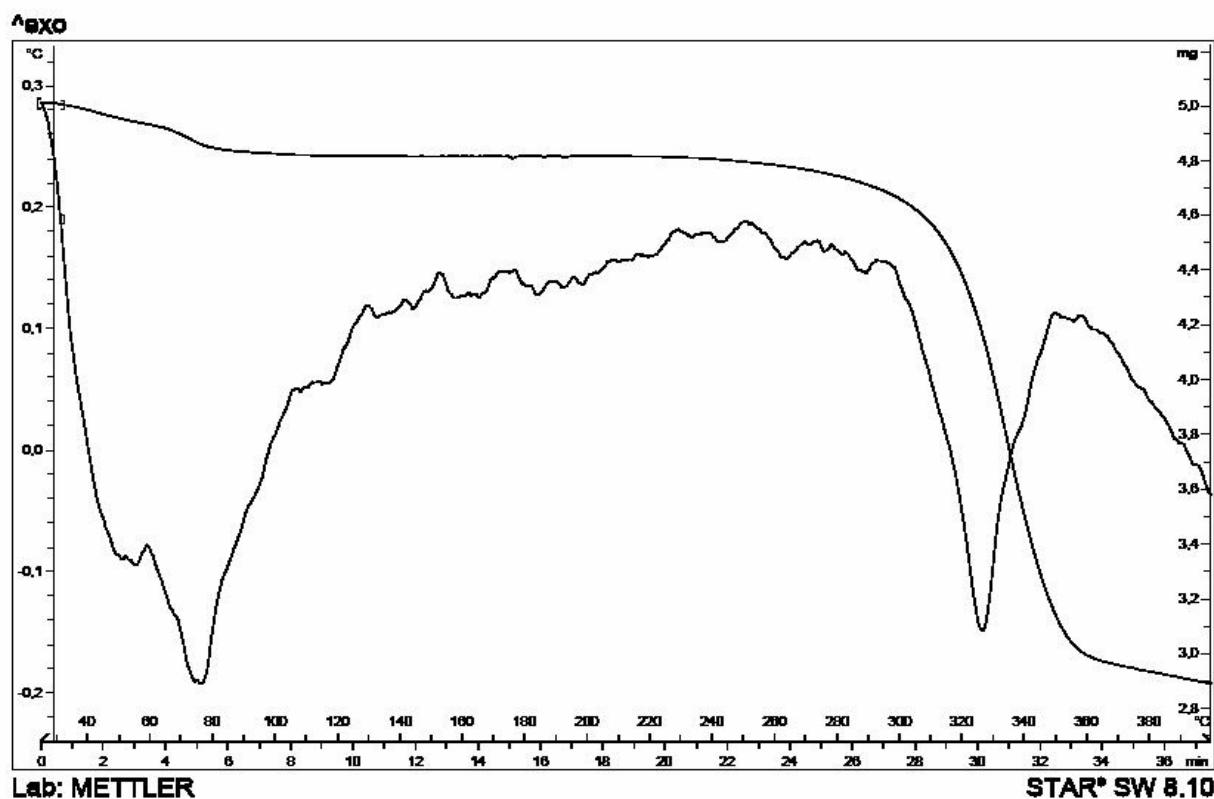
Figura 28. Curva de aquecimento obtida por DTA e curva termogravimétrica para a mistura binária equiponderal entre a luteolina e a celulose microcristalina
