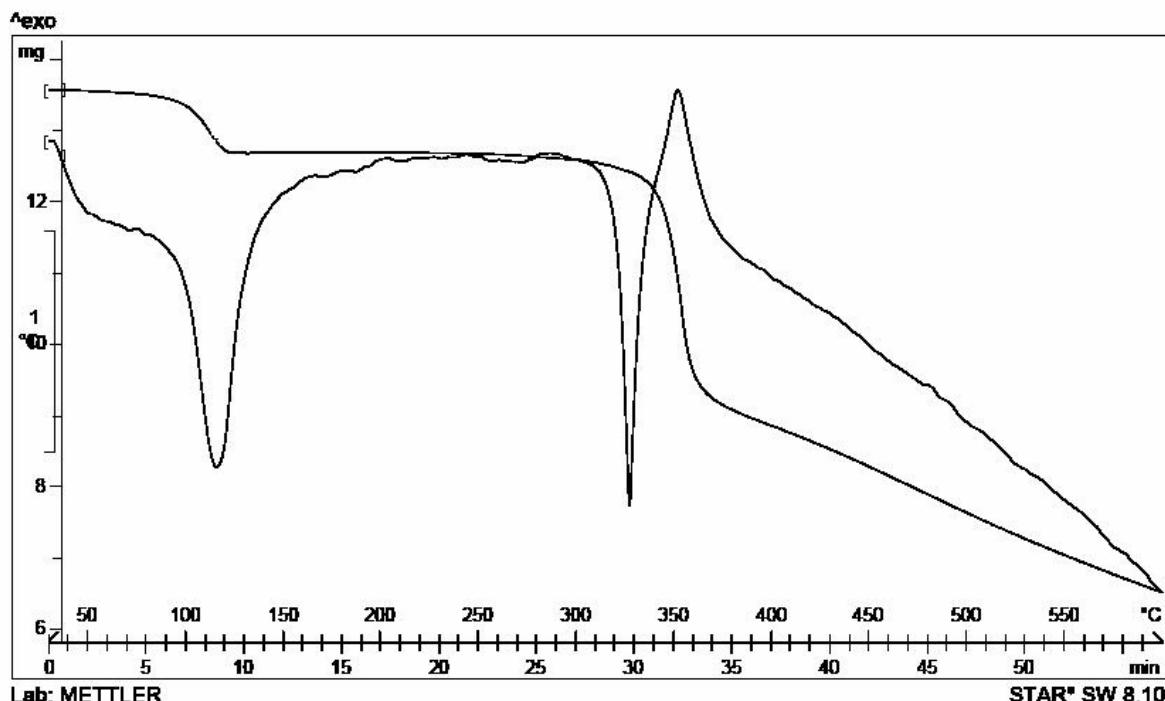
Figura 48. Curva de aquecimento obtida por DTA e curva termogravimétrica para a quercetina amostra
