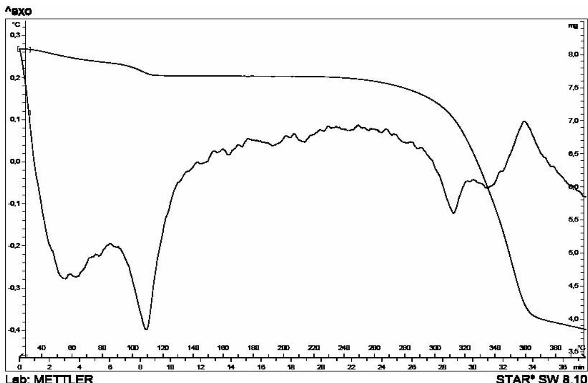
Figura 52. Curva de aquecimento obtida por DTA e curva termogravimétrica para a mistura binária na proporção ponderal de 1:2 entre a queracetina e a celulose microcristalina
