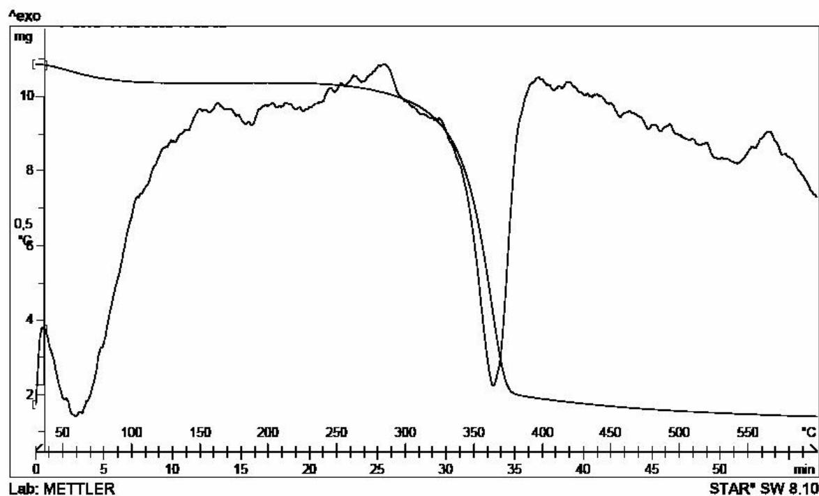
Figura 8. Curva de aquecimento obtida por DTA e curva termogravimétrica para a celulose microcristalina
