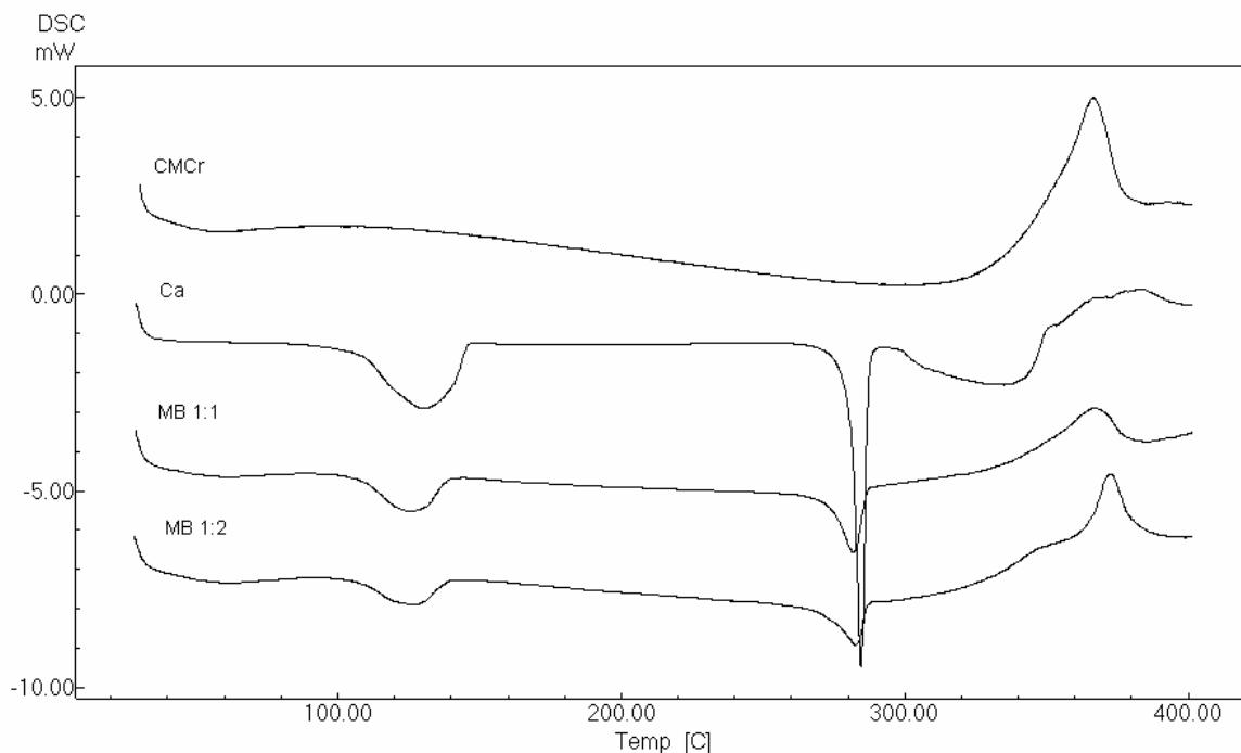
Figura 12. Curvas de aquecimento obtidas por DSC para o canferol (Ca) e a celulose microcristalina (CMCr) e para suas misturas binárias (MB) nas proporções ponderais 1:1 e 1:2
