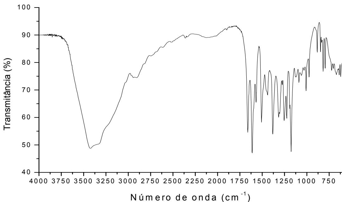
Figura 17. Espectro na região do infravermelho da mistura binária de canferol e celulose microcristalina na proporção ponderal 1:2
