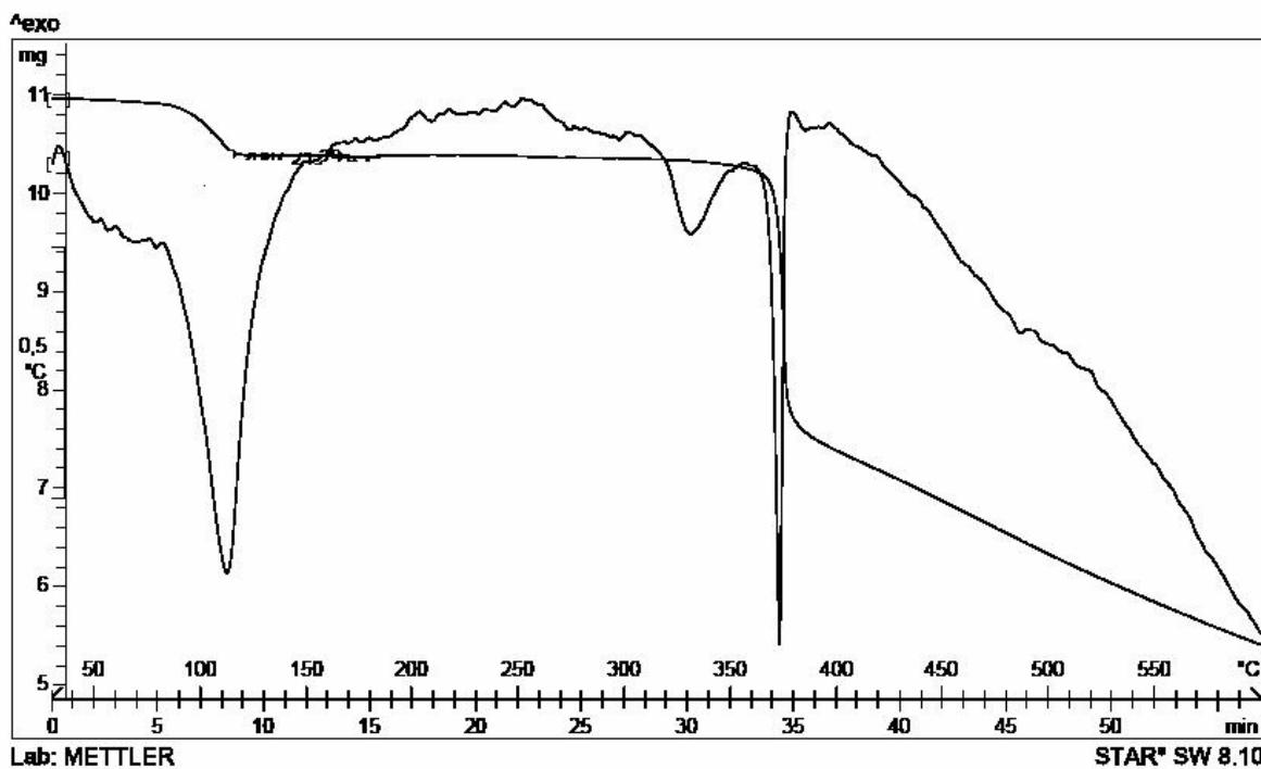
Figura 34. Curva de aquecimento obtida por DTA e curva termogravimétrica para a miricetina
