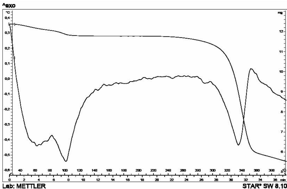
Figura 37. Curva de aquecimento obtida por DTA e curva termogravimétrica para a mistura binária na proporção ponderal de 1:2 entre a miricetina e a celulose microcristalina
