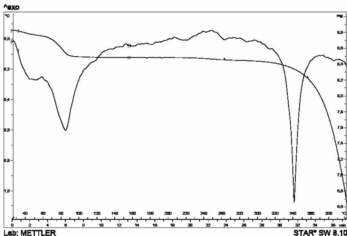
Figura 27. Curva de aquecimento obtida por DTA e curva termogravimétrica da luteolina
