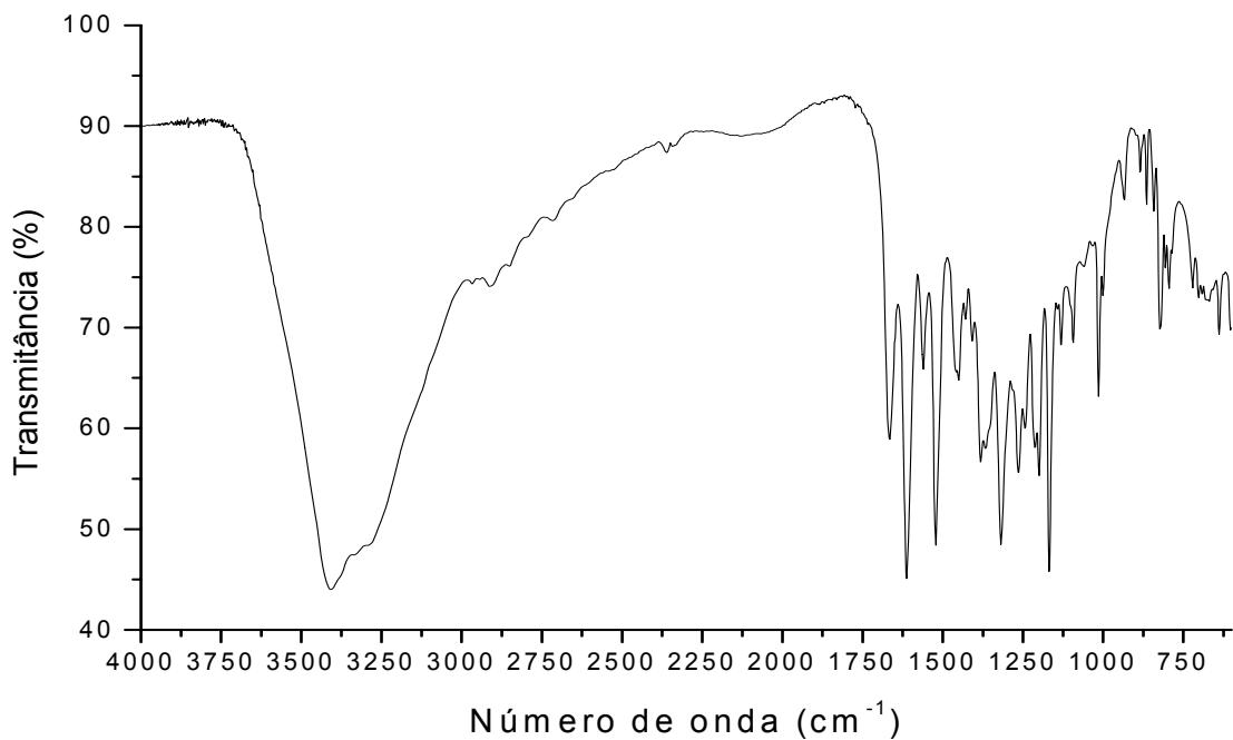
Figura 53. Espectro na região do infravermelho da mistura binária entre a quercetina e a celulose microcristalina na proporção ponderal 1:2
