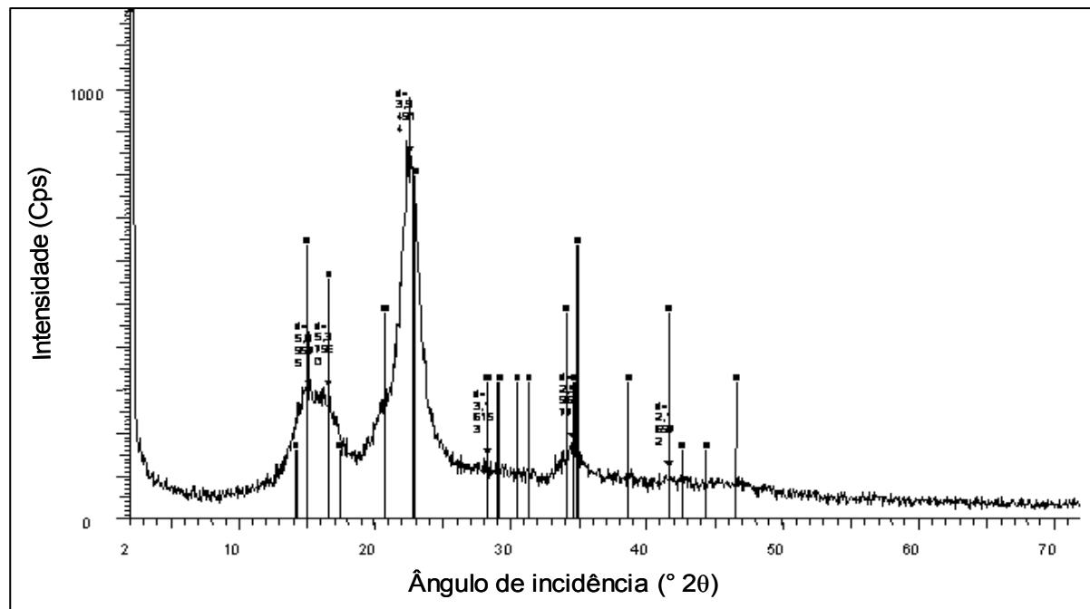
Figura 9. Difratograma obtido por difratometria de raios-X para a celulose microcristalina e referência de celulose microcristalina ( )
