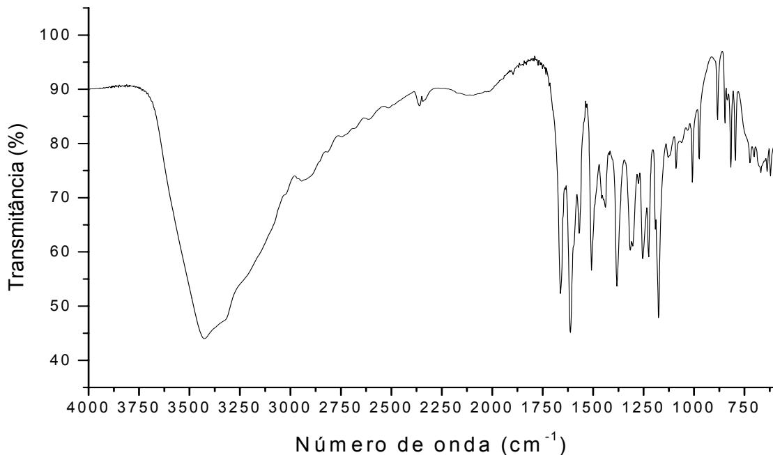
Figura 15. Espectro na região do infravermelho da mistura binária equiponderal entre o canferol e a celulose microcristalina
