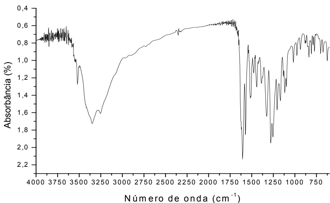
Figura 22. Espectro na região do infravermelho da mistura binária equiponderal entre a fisetina e a celulose microcristalina
