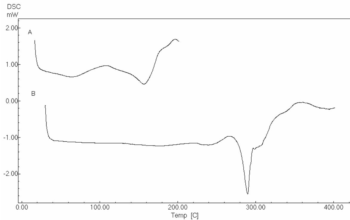
Figura A9. Curvas de aquecimento por DSC para a morina (A: primeiro aquecimento até 200 °C e B: segundo aquecimento até 400 °C)
