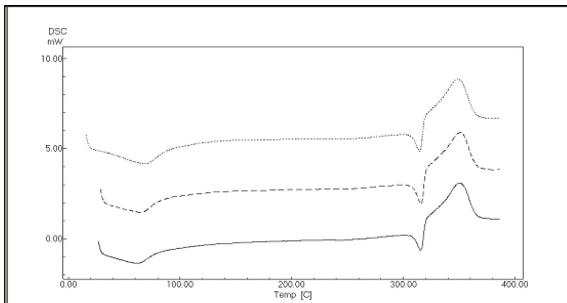
Figura 10. Curvas de aquecimento obtidas por DSC para as misturas físicas equiponderais de celulose microcristalina e quercetina
