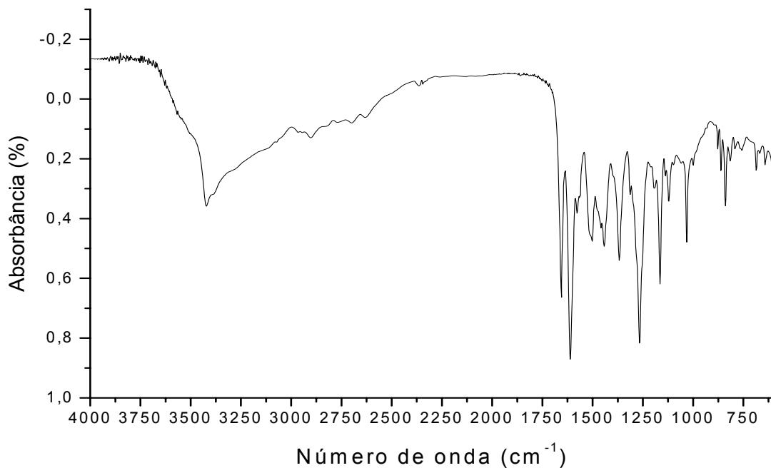
Figura 31. Espectro na região do infravermelho da mistura binária luteolina e celulose microcristalina na proporção ponderal 1:2
