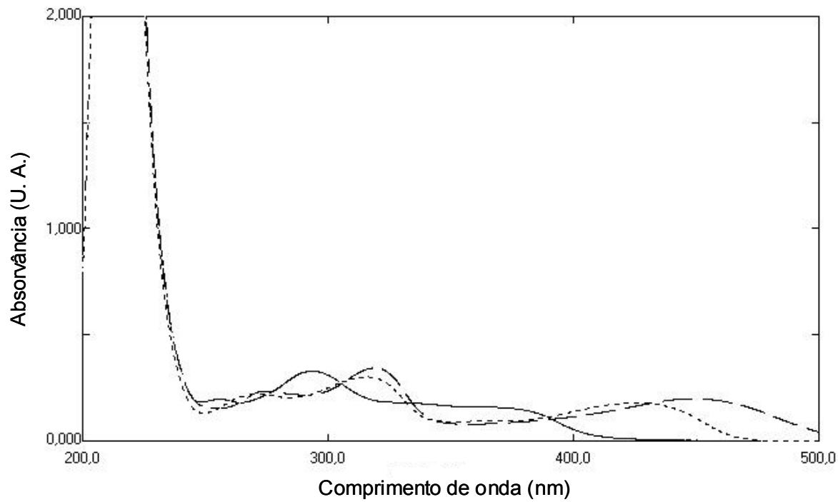
Figura A6. Espectro na região do UV-visível para a solução de quercetina amostra em metanol (—), após complexação com  $\text{AlCl}_3$  (---) e subsequente hidrólise com  $\text{HCl}$  (...)
