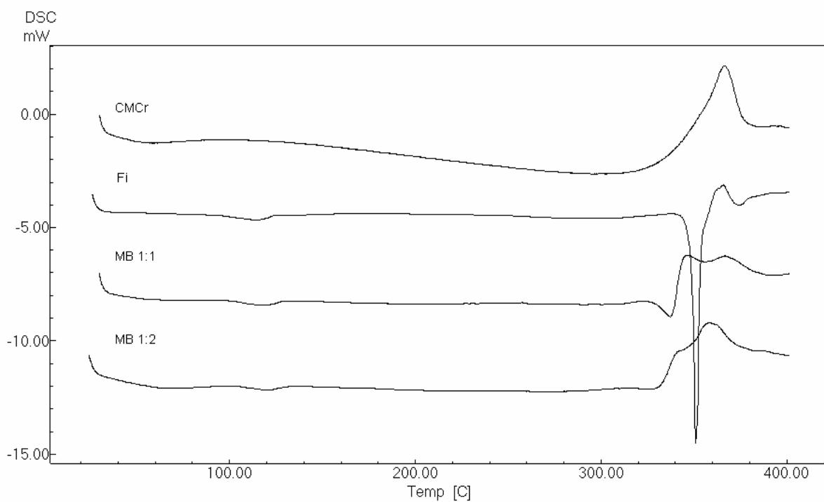
Figura 19. Curvas de aquecimento obtidas por DSC para a fisetina (Fi) e a celulose microcristalina (CMCr) e para suas misturas binárias (MB) nas proporções ponderais de 1:1 e 1:2
