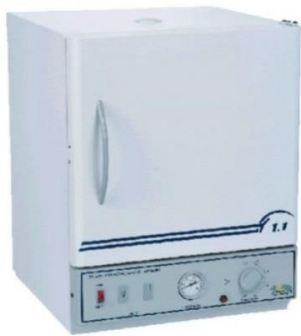
Figura 15. Foto ilustrativa da estufa (acima e à direita) utilizada para o envelhecimento das amostras durante 100 h à 200 °C e, do forno com o sistema de vácuo (acima e à esquerda) utilizado para o recozimento das amostras em temperaturas que podem atingir 1100 °C durante um tempo de 1 h.
