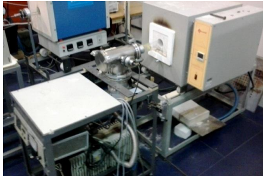
Figura 15. Foto ilustrativa da estufa (acima e à direita) utilizada para o envelhecimento das amostras durante 100 h à 200 °C e, do forno com o sistema de vácuo (acima e à esquerda) utilizado para o recozimento das amostras em temperaturas que podem atingir 1100 °C durante um tempo de 1 h.
