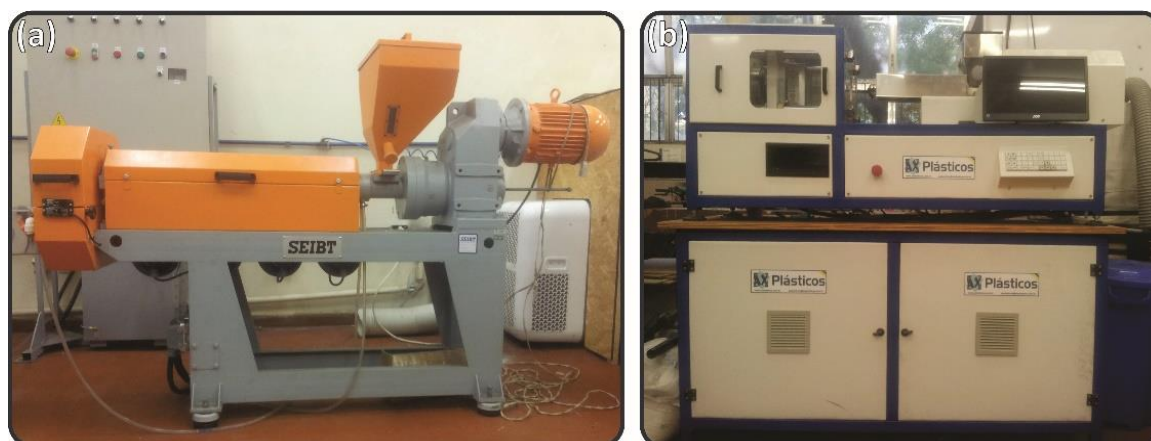
Equipamentos utilizados no processo: (a) Extrusora, (b) Injetora.
