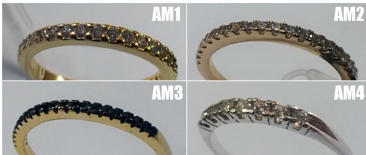
Figura 16 – Constância e precisão no dimensionamento dos granitos nos corpos de prova AM2 e AM3, em contraponto à falta dessas características em AM1 e AM4, devido a ajustes manuais
