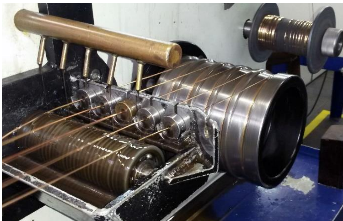
Figura 7 – Processo de trefilagem, cinco feiras adaptadas na máquina para a redução gradual da espessura do fio de metal.
