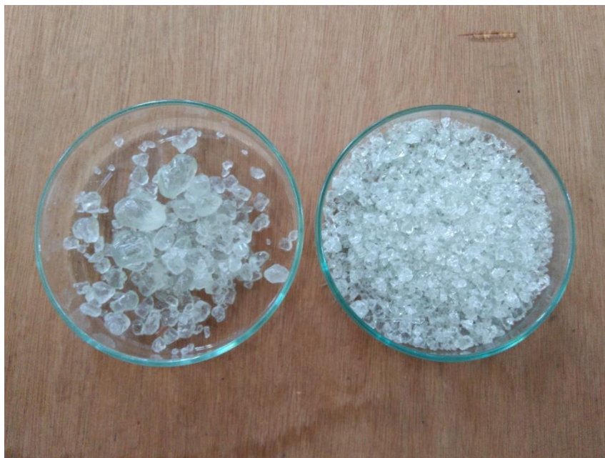
Figura 3.6. Fritas cerâmicas produzidas em laboratório a esquerda e comercial a direita.
