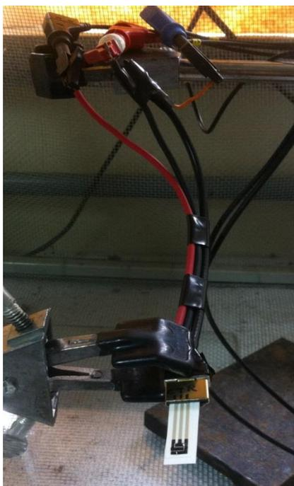
Figura 11: Sistema utilizado para os testes de voltametria cíclica
