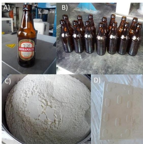
Figura 3.1- A) Garrafa selecionada para elaboração das peças. B) garrafas limpas e sem rótulo, prontas para a moagem. C) Vidro moído e peneirado, separado para a elaboração da mistura final. D) Peça prensada e pronta para ser levada ao forno para a queima.
