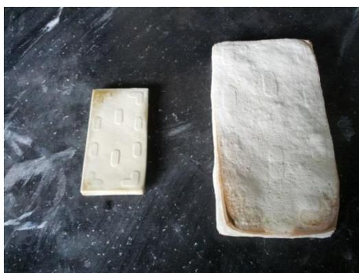
Figura 3.3 – A esquerda amostra prensada, antes da queima, e a direita corpo de provas após ser retirado do forno.
