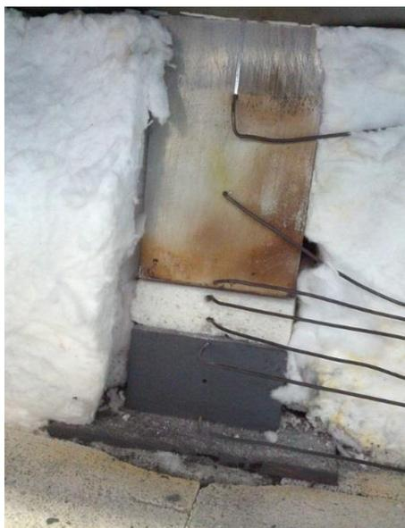
Figura 3.4 – Amostra posicionada para análise no forno de testes.
