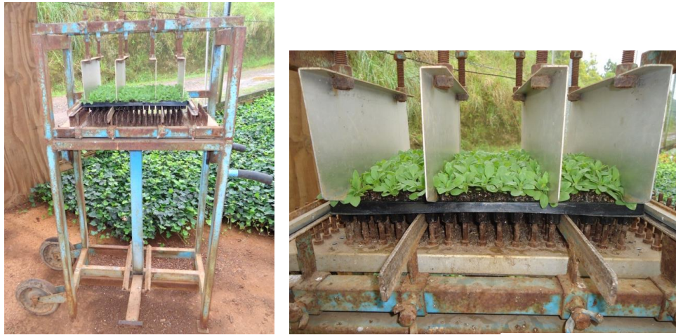
Figura 8 – Máquina utilizada para soltar os plugs das mudas em bandejas de 204 células.
