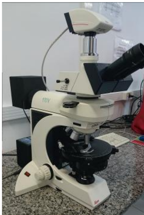
Figura 9: Microscópio modelo Leica ® DMLP e câmera fotográfica Leica ® DC 300F, utilizados para as descrições petrográficas e obtenção das fotomicrografias, respectivamente.
