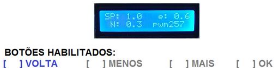
Figura 3.11 – Tela de visualização do controlador em malha-fechada
