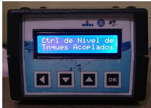
Figura 3.4 – Interface IHM e botões de navegação
