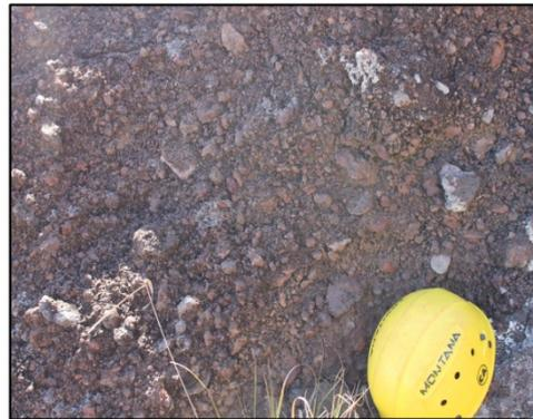
**Bri**: Brecha com graduação inversa de um lapilito maciço até nível com concentração de clastos de escória, fragmentos de lava coerente e raros fonólitos. A base do fluxo é marcada por fina camada de Ltm.
