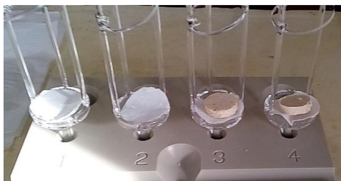
Figura 5. Amostra de quinoa em forma de comprimido, posicionada na base do suporte de quartzo utilizado.
