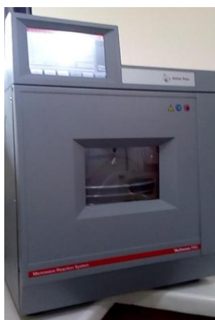
Figura 2. Forno de micro-ondas comercial utilizado para a decomposição por via úmida e combustão iniciada por micro-ondas.
