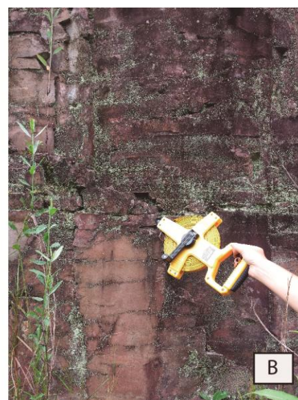
Figura 14: (A) visão geral do segmento na direção sul; (B) fraturas horizontais com espaçamento médio de 10cm
