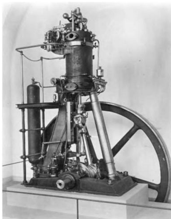
Figura 3: Primeiro motor por combustão interna inventado por Rudolph Diesel 33,34 .
