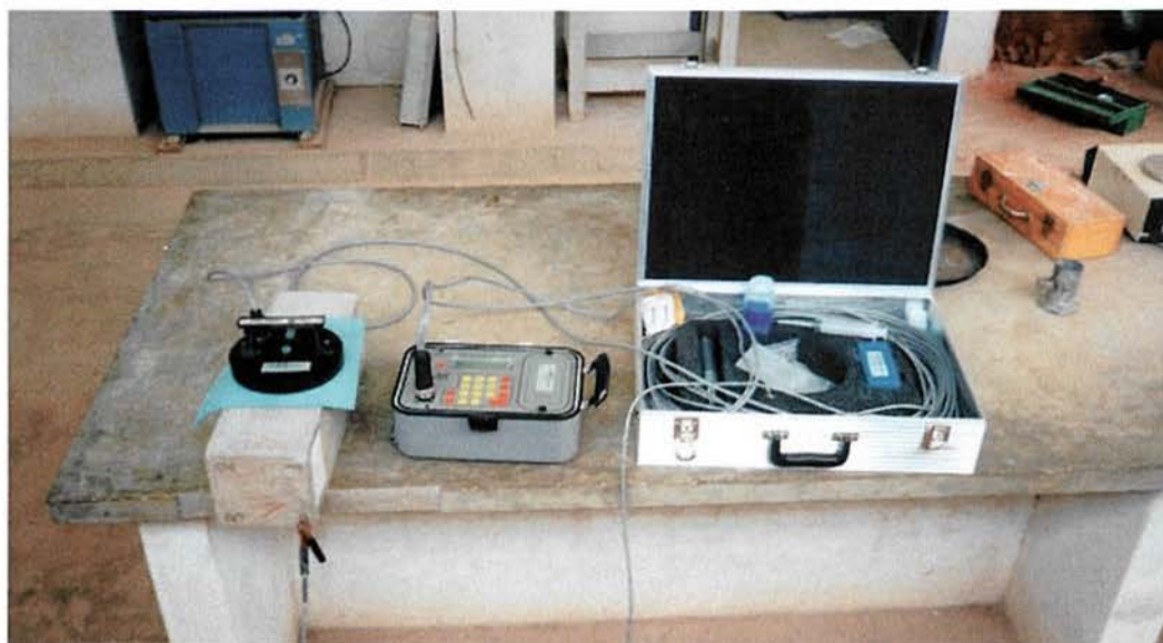
FOTO 8.1 GECOR6 – aparelho utilizado para realizar leituras eletroquímicas nas vigas de concreto.
