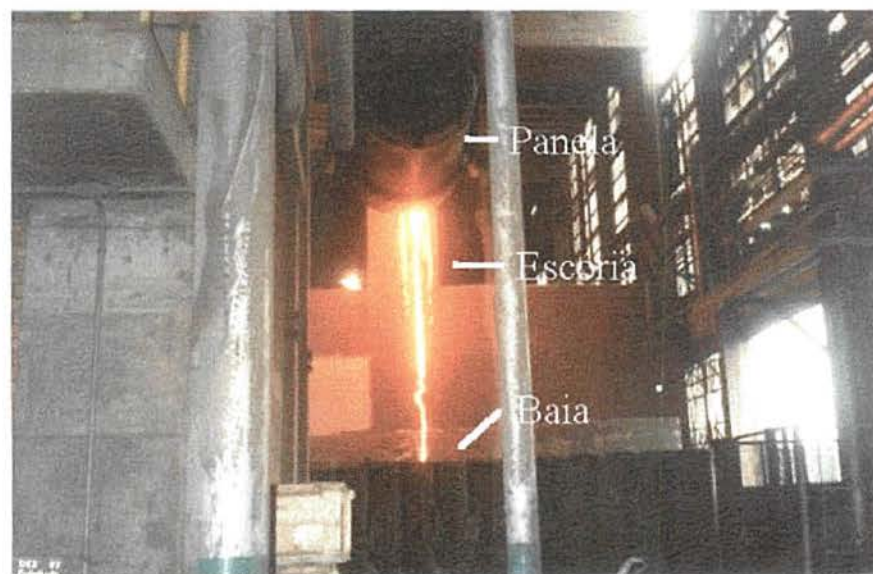
FOTO 2.1 Escória do refino redutor sendo vazada da panela diretamente na baia de escória.
