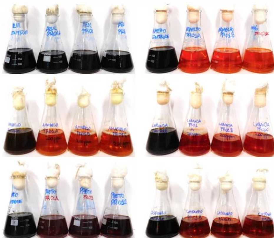
Figura 9 - Avaliação qualitativa de remoção de cor, em ordem da esquerda para direita e de cima para baixo, pelo isolado Trametes sp. PR01 dos corantes: AA161, VA357, AA79, LA142, PA210 e MA414. Todas as fotos foram tiradas de amostras filtradas após 8 dias de incubação em meio MEB a 30°C e 200 rpm.
