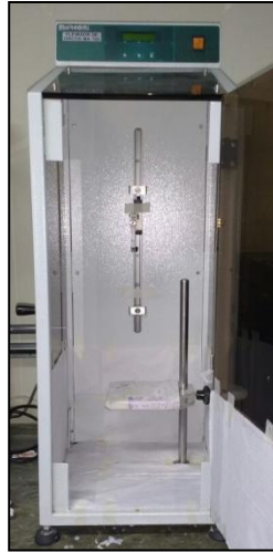
Figura 11 – Equipamento para revestimento dos corpos de prova por imersão dip coating
