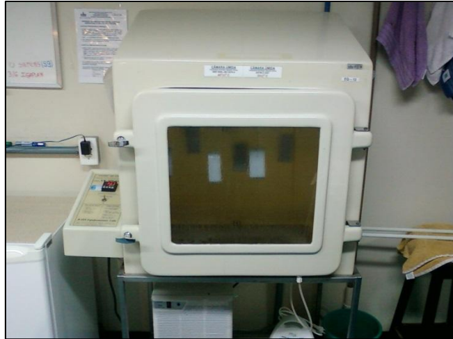
Figura 19 – Equipamento de ensaio acelerado em Câmara Úmida (LACOR).
