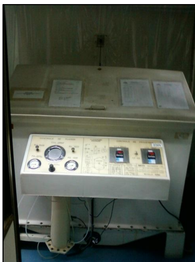
Figura 18 – Câmara de ensaio acelerado em Névoa Salina (LACOR).
