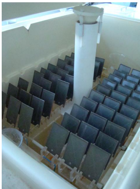
Figura 24 – Sistema de fixação na câmara de névoa salina das chapas metálicas revestidas com as tintas em pó base epóxi contendo diferentes teores (2, 4 e 8 % (m/m)) de MMT-NaCe, OMMT-30BCe ou OMMT-15ACe.
