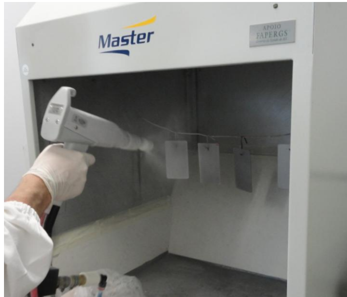
Figura 20 – Processo de aplicação da tinta por pulverização eletrostática.
