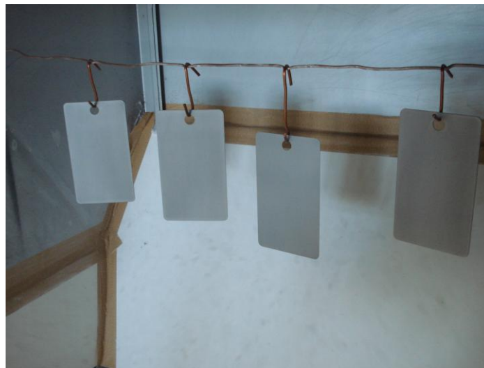
Figura 19 – Painéis de aço carbono fixados na cabine de pintura antes da aplicação da tinta.
