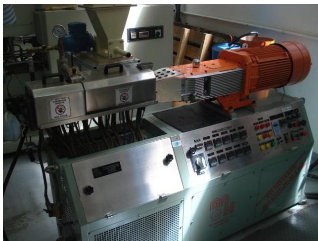
Figura 15 – Extrusora duplarroscas utilizada para obtenção das tintas em pó.
