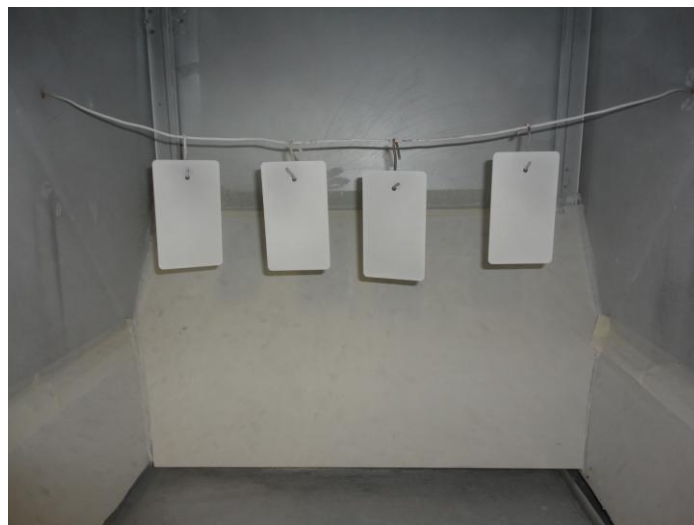
Figura 21 – Aparência física dos painéis após a aplicação da tinta.
