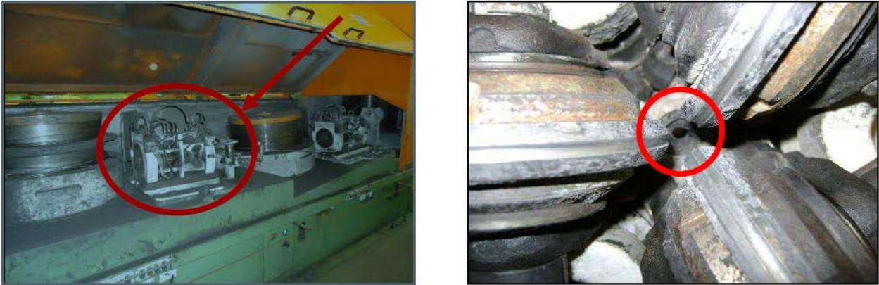
Figura 3.5 - Cassetes Laminadores montados na máquina, e detalhe da disposição dos discos de metal duro a 120° [GERDAU 2011]
