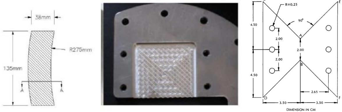
Figura A.6: (a)Corpo de prova usado por Adkins,2011; (b) Fixação usada por Adkins,2011; (c)Corpo de prova usado por Yen, 1988.
