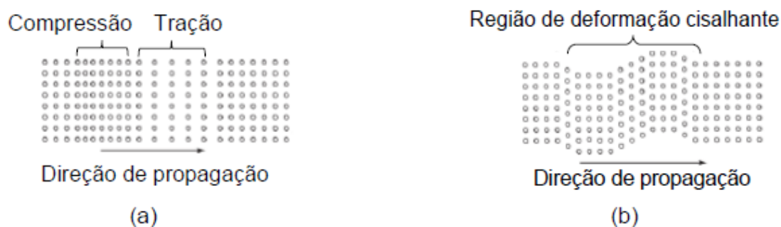
Figura 3.1 – Ondas longitudinais (a) e transversais (b).
