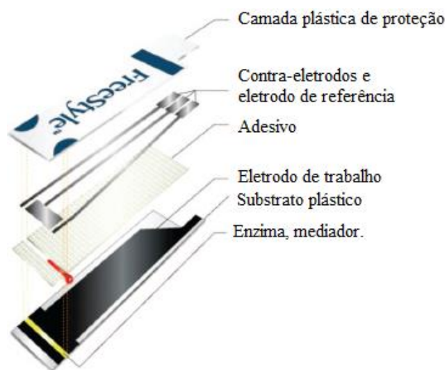
Figura 11 - Visão ampliada da estrutura de uma tira eletroquímica comercial para monitoramento de glicose usada para o controle de diabetes, preenchida parcialmente no adesivo com uma gota de sangue.
