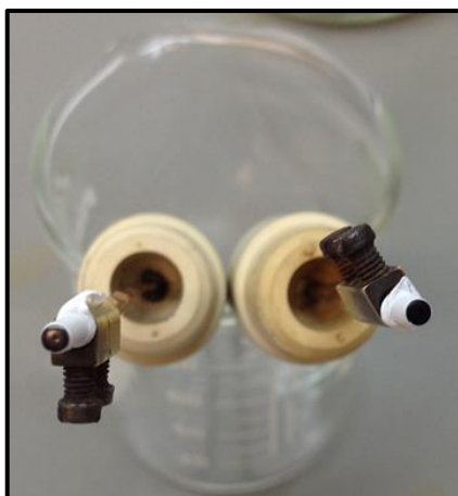
Figura 16 - Eletrodos de Carbono Vítreo, da esquerda recoberto com PEDOT e tratado com tratamento corona e da direita recoberto com filme de PEDOT.
