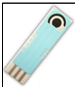
Figura 17 - Sensor marca DropSens, modelo DRP-C110 com três eletrodos.
