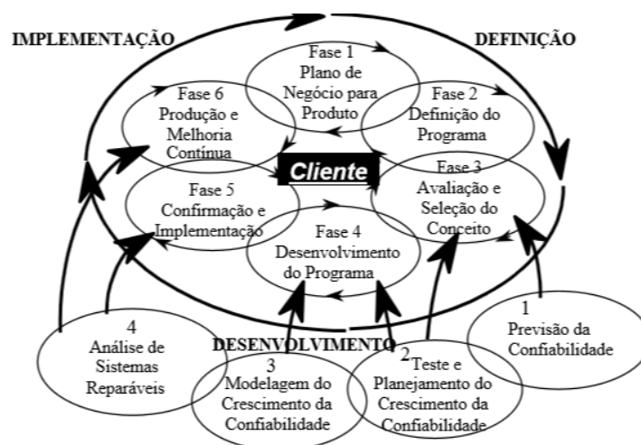
Figura 3.7: Processo de desenvolvimento de produto e etapas do gerenciamento do crescimento da confiabilidade John Deere
