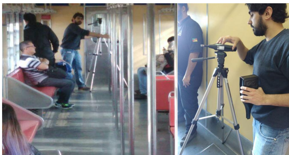
Figura 4.2 – Decibelímetros fixados em tripés, a 1,6m do piso, na linha central ao eixo longitudinal.
