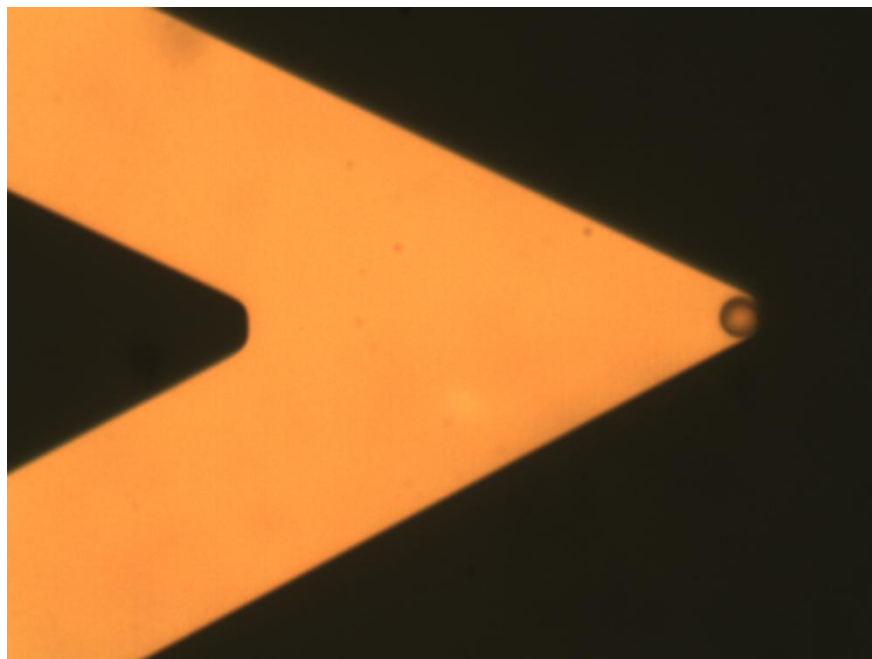
Figura 11. Imagem (obtida por microscopia óptica) da sonda coloidal de sílica (Sonda 1) utilizada nas medidas de força de interação bolha-partícula hidrofílica. Esfera com d_p igual a 5,6 \mu\text{m} fixa em cantilever de 0,12 \text{ N m}^{-1} ( k_c nominal).
