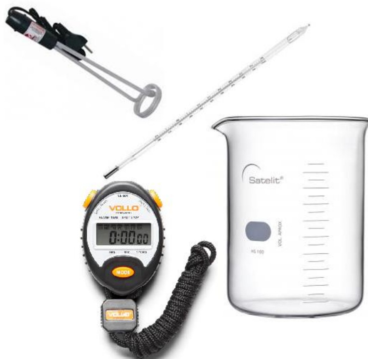
Figura C.6: Materiais necessários para o experimento: cronômetro, vidro Becker, aquecedor elétrico e termômetro.
