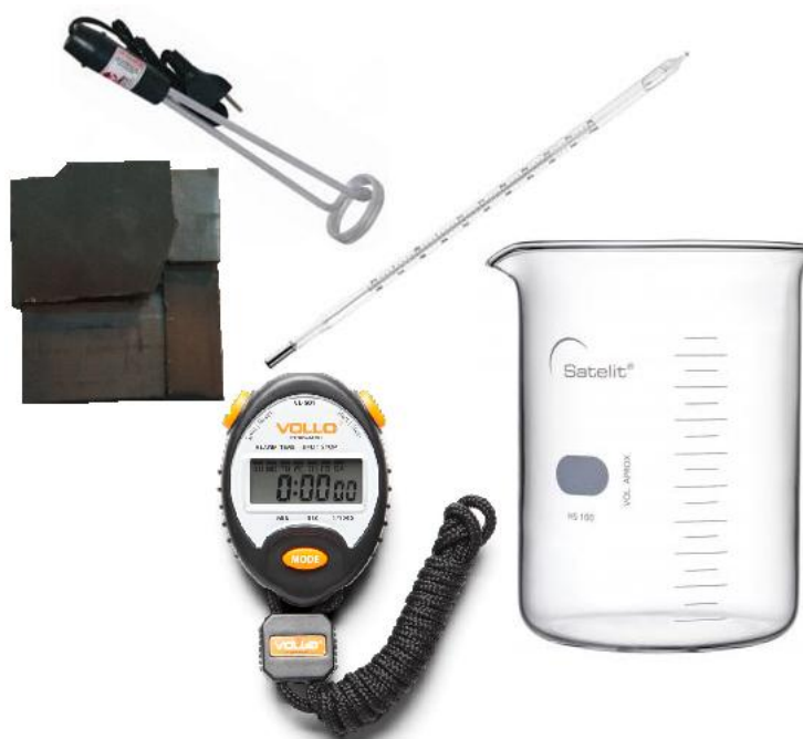
Figura 5: Materiais necessários para o experimento: cronômetro, vidro Becker, aquecedor elétrico, pedaços de alumínio e termômetro.
