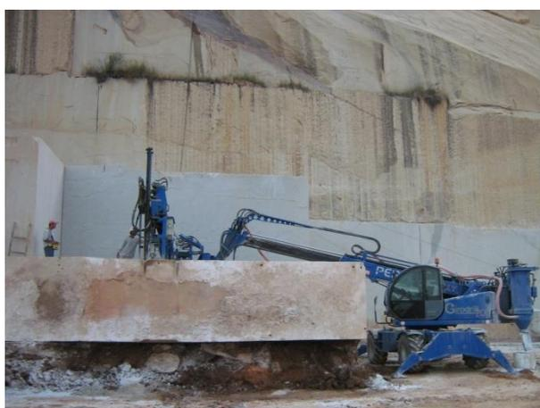
Figura 23 – Perfuratriz montada em trator com braço escamoteável. Fonte: SGM
