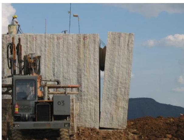
Figura 25 – Método de tombamento de bloco por colchão de ar. Fonte: SGM
