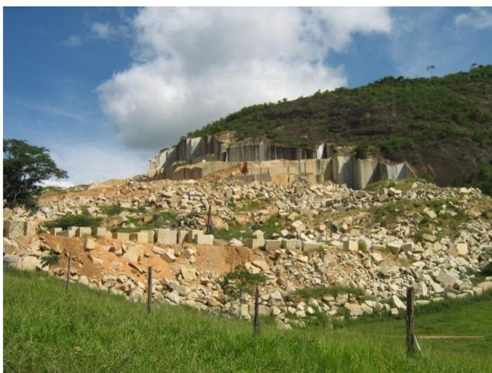
Figura 28 – Rejeitos mal dispostos na frente de lavra impactam e dificultam a extração. Fonte: SGM
