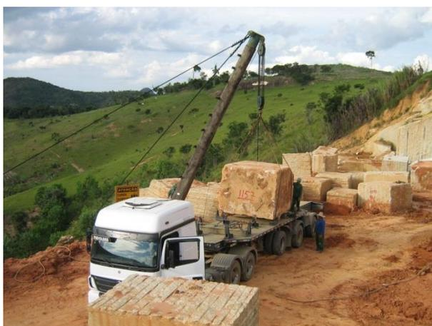
Figura 26 – Carregamento de blocos por pau de carga. Fonte: SGM
