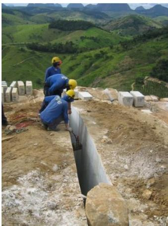
Figura 24 – Método de tombamento de bloco por macaco hidráulico. Fonte: SGM
