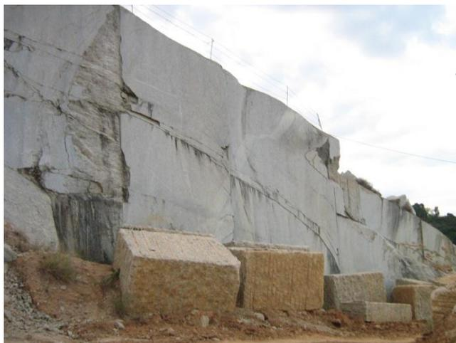
Figura 35 – Trincas na suíte Carlos Chagas dificultam extração. Fonte: SGM
