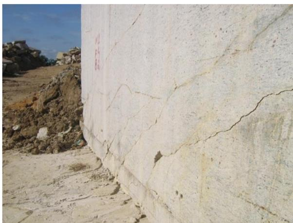
Figura 34 – Trincas em excesso inviabilizam a extração. Fonte: SGM
