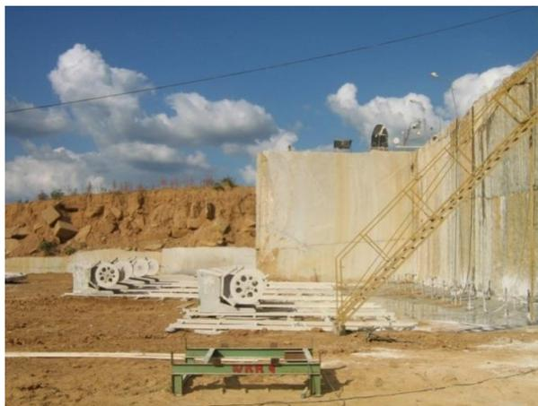
Figura 22 – Máquinas de fio diamantado utilizadas com frequência nas operações de lavra. Fonte: SGM
