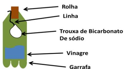
**Figura 6: Esquema de montagem do foguete**
