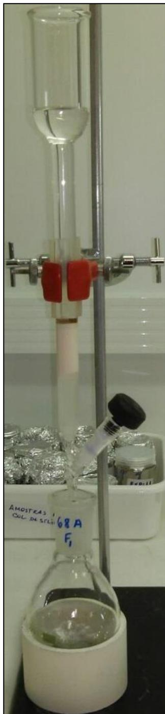
Figura 21: Coluna de cromatografia líquida, camadas (de baixo para cima):  $\text{SiO}_2$  (incolor),  $\text{Al}_2\text{O}_3$  (branca) e  $\text{Na}_2\text{SO}_4$  (branca). Camada marrom corresponde a amostra recém depositada (ainda não iniciado o processo de separação)
