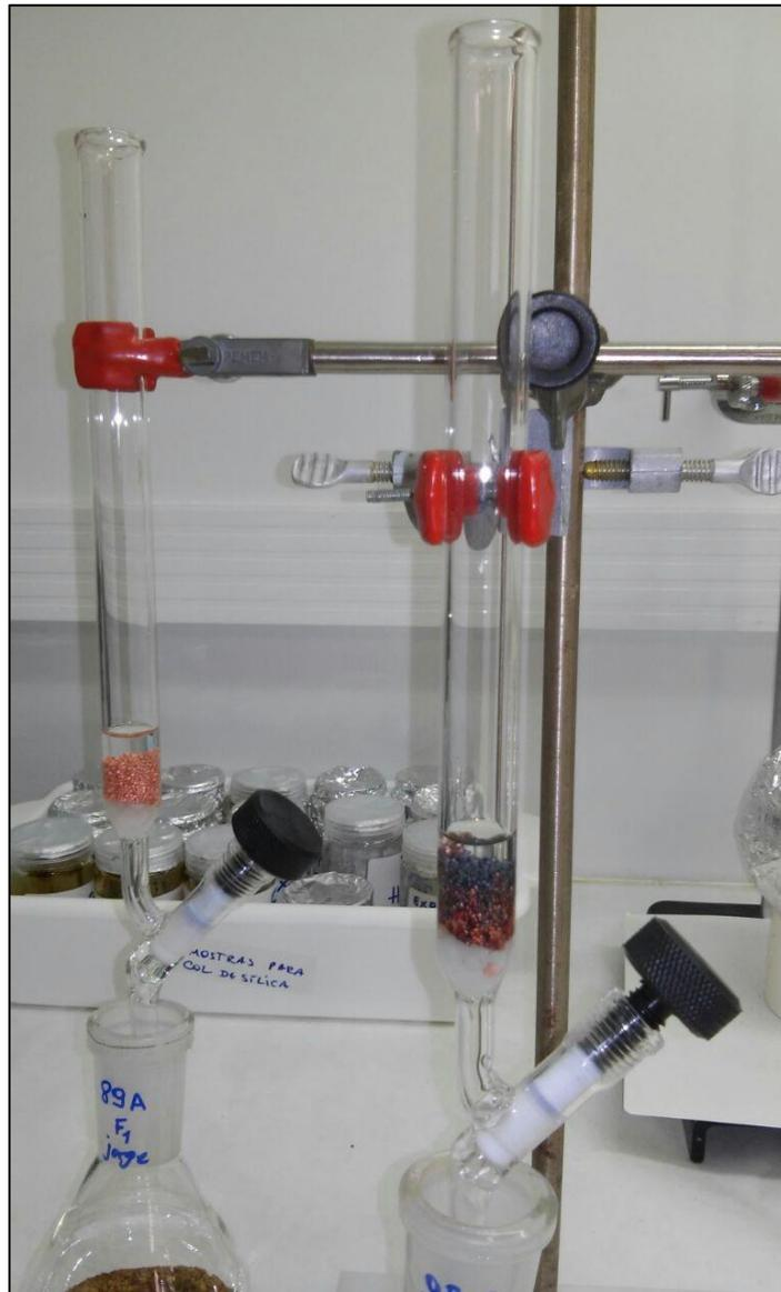
Figura 20: Coluna de cobre para remoção de enxofre (o escurecimento decorre da reação do enxofre presente com o cobre metálico)
