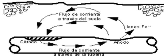
Figura 2.3 Tubería encerrada, la zona con tendencia anódica cede electrones y la zona de tendencia catódica los recibe. (NAVARRETE, 2008).
