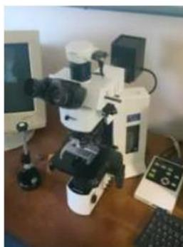
Figura 3.1 Microscópio Olympus BX51/DP20.
