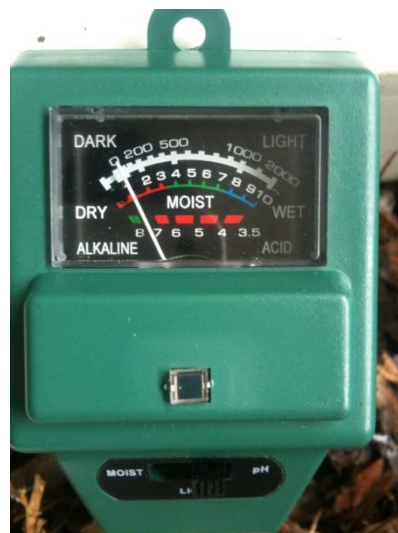
Figura 30 – Aparelho utilizado para medição de umidade e pH nas vermicomposteiras Fonte: Autor
