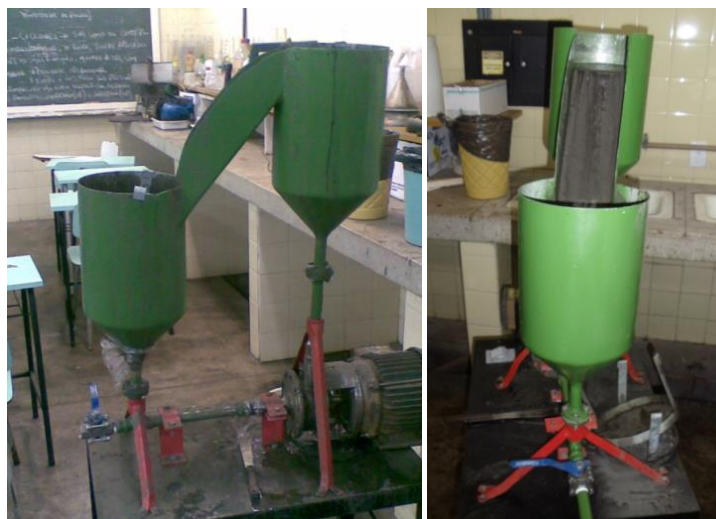
Figura 8. Equipamento separador por meio denso de Fe-Si.
