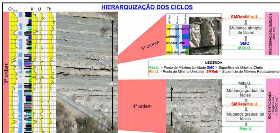
Figura 6.1: Hierarquia das seqüências estratigráficas e suas superfícies observadas no intervalo Balbuena IV na porção central da Sub-bacia Metán-Alemania. Modificado de LYKAWKA et al. , (2012).
