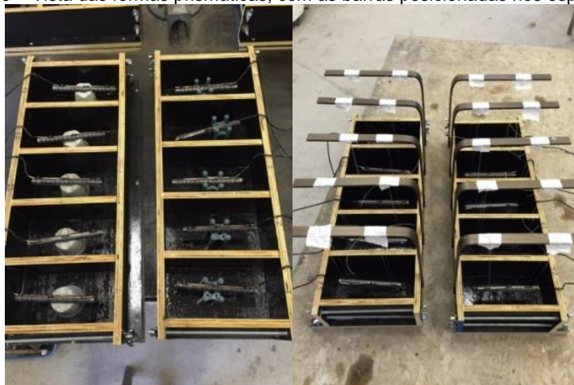
Figura 20 – Vista das formas prismáticas, com as barras posicionadas nos espaçadores
