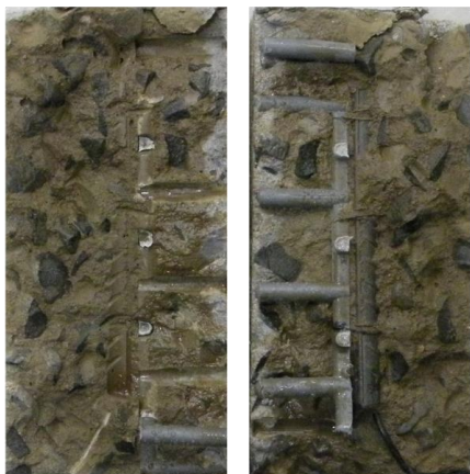
Centopeia de Plástico – 4 dias de ensaio – cura úmida
