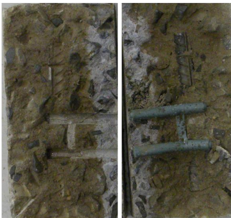
Torre de Plástico – 8 dias de ensaio – cura úmida
