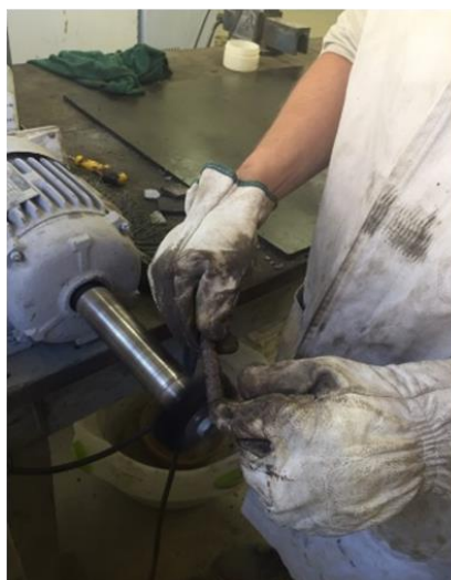
Polimento com escova de aço rotativa para eliminar quaisquer resquícios de concreto
