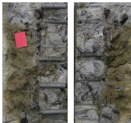
Centopeia de Plástico – 4 dias de ensaio – ciclos de calor
