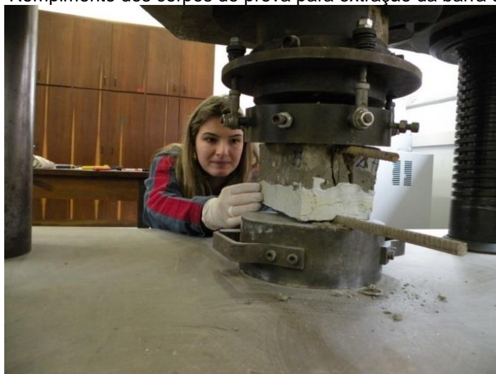
Figura 31 – Rompimento dos corpos de prova para extração da barra de armadura
