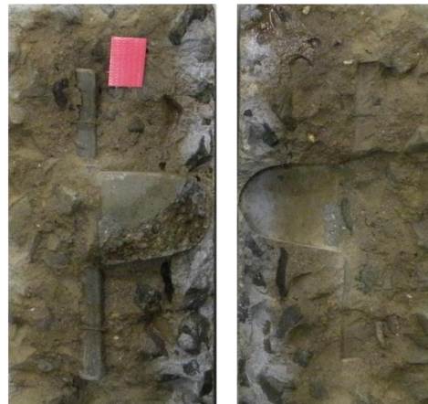
Prisma de Argamassa – 4 dias de ensaio – ciclos de calor
