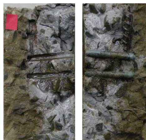
Torre de Plástico – 4 dias de ensaio – ciclos de calor
