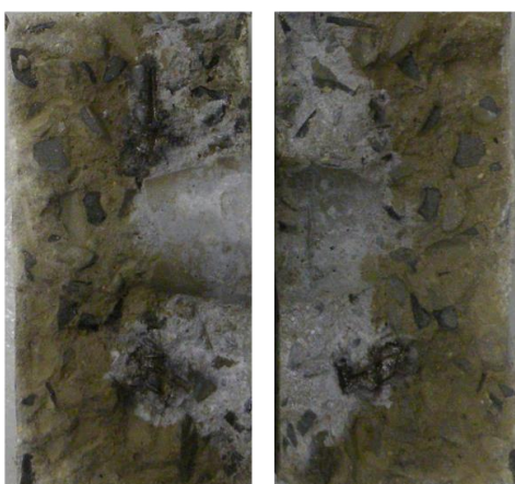
Torre de Argamassa – 8 dias de ensaio – cura úmida
