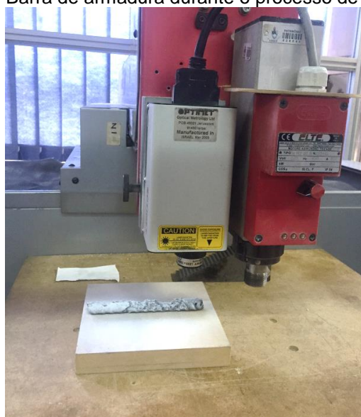
Figura 33 – Barra de armadura durante o processo de digitalização
