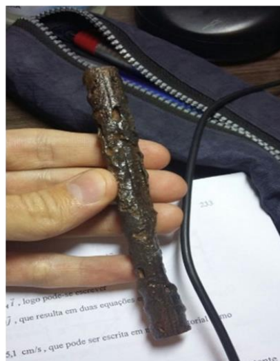
Barra pronta para ir para o ensaio de Redimensionamento a Laser
