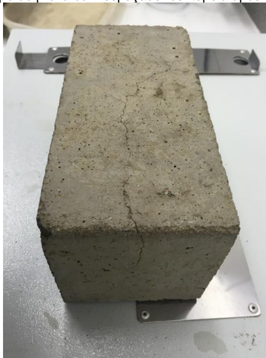
Figura 36 – Corpo de prova com espaçador centopeia após os ciclos de calor
