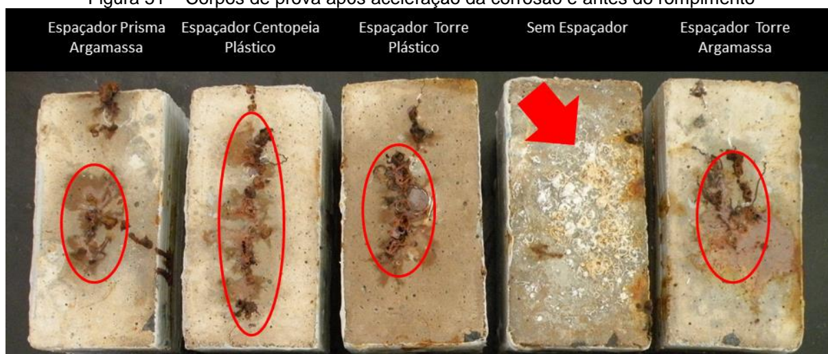
Figura 51 – Corpos de prova após aceleração da corrosão e antes do rompimento
