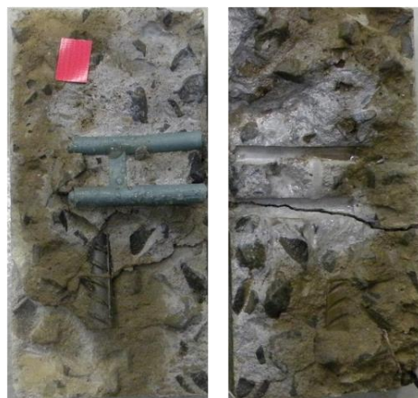
Centopeia de Plástico – 4 dias de ensaio – ciclos de calor
