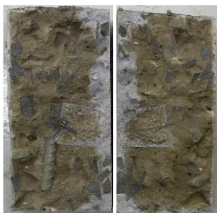
Prisma de Argamassa – 8 dias de ensaio – cura úmida
