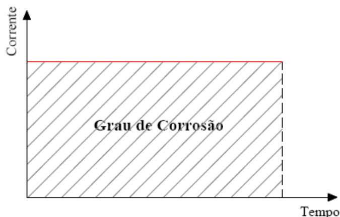
Figura 24 – Grau de corrosão pela Lei de Faraday
