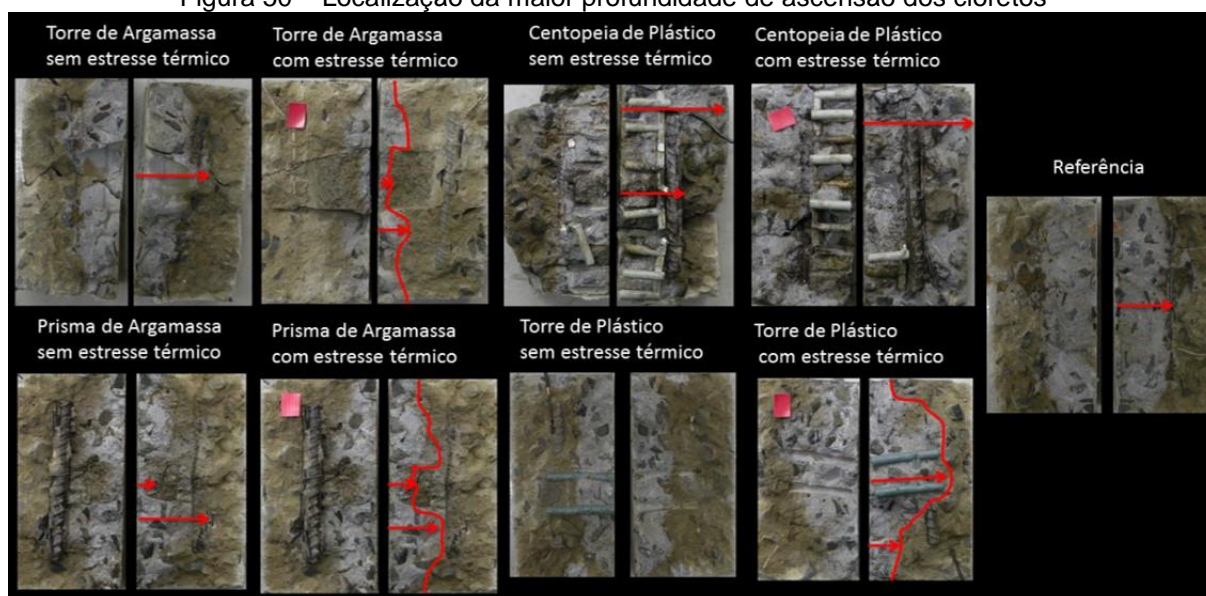
Figura 50 – Localização da maior profundidade de ascensão dos cloretos
