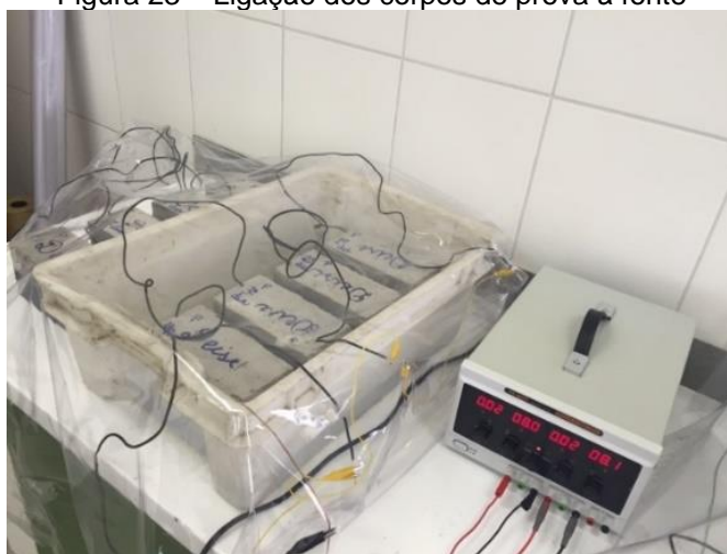
Figura 23 – Ligação dos corpos de prova à fonte
