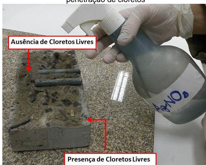
Figura 29 – Aspersão de Solução de Nitrato de Prata sobre o corpo de prova para verificação da penetração de cloretos
