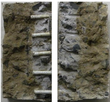
Centopeia de Plástico – 8 dias de ensaio – cura úmida
