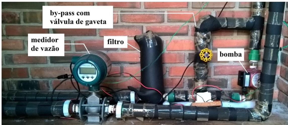
Figura 4.4 – Imagem dos equipamentos utilizados na tubulação do fluxo de água.
