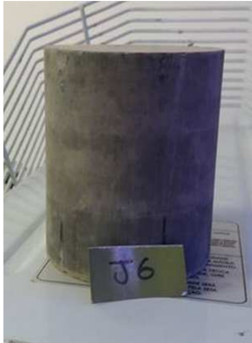
Figura 33 – Corpo-de-prova após moldagem (100mm x 120mm)
