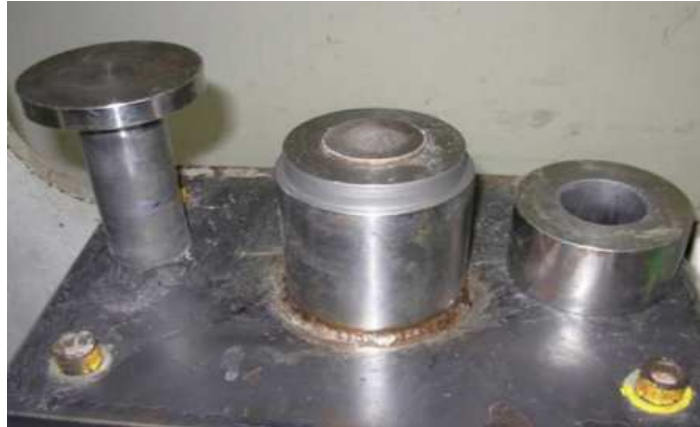
Figura 31 – Molde utilizado para os corpos-de-prova dos ensaios de resistência à compressão simples
