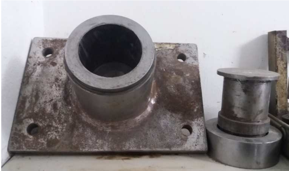
Figura 25 – Molde utilizado para confecção dos corpos-de-prova
