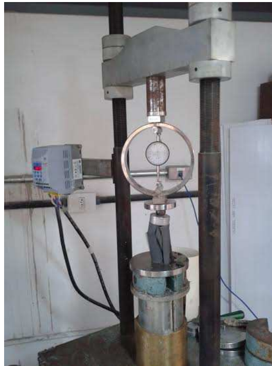
Figura 32 – Posicionamento e prensa utilizada nos ensaios de resistência à compressão simples
