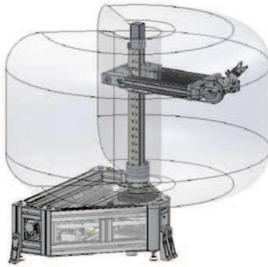
Figura 4.1 – Espaço de trabalho do robô pneumático.
