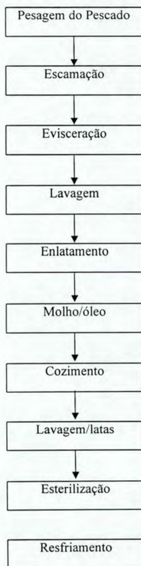
Figura 7: Fluxograma operacional para pescado enlatado Fonte: Adaptado de SUDEPE (1988)
