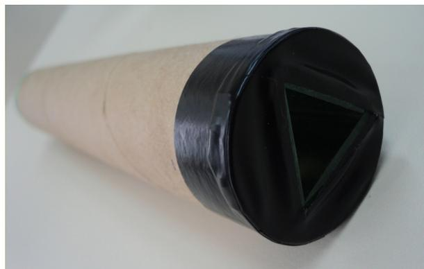
Figura 1: Caleidoscópico de tubo de papel toalha com três espelhos retangulares e fita isolante.
