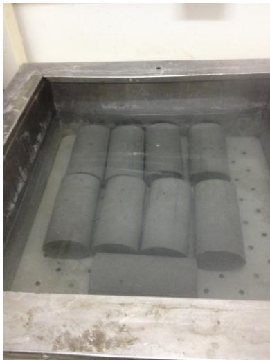
Figura 20 – Corpos de prova armazenados em banhos térmicos com temperatura de 25^{\circ}\text{C} após a desmoldagem e retirada dos sacos plásticos
