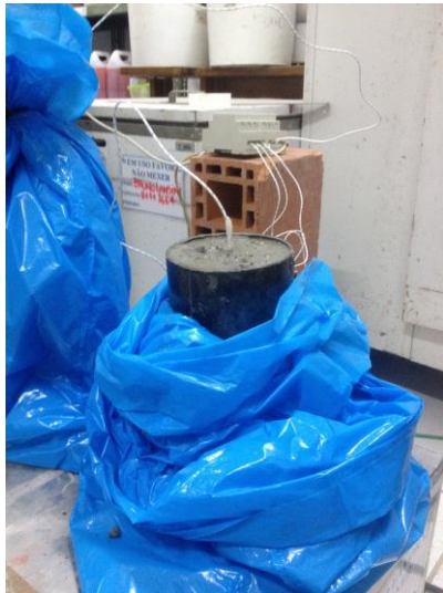
Figura 26 – Corpo de prova com termopar posicionado
