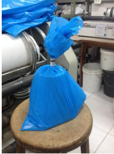
Figura 19 – Aspecto visual do corpo de prova preparado para receber o processo de cura
