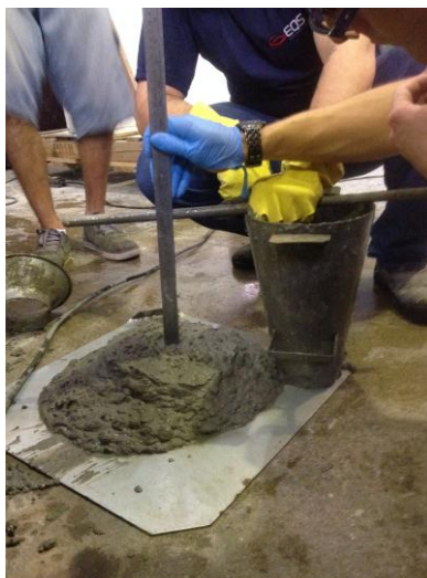
Figura 18 – Ensaio de abatimento do concreto
