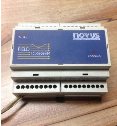
Figura 23 – Aparelho para medição e registro das temperaturas (Field Logger)
