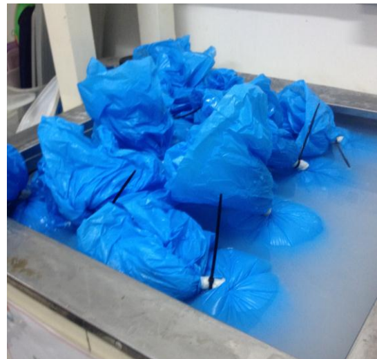
Figura 21 – Corpos de prova envoltos e fechados em sacos plásticos posicionados em banho térmico com temperatura controlada = 60^{\circ}\text{C}
