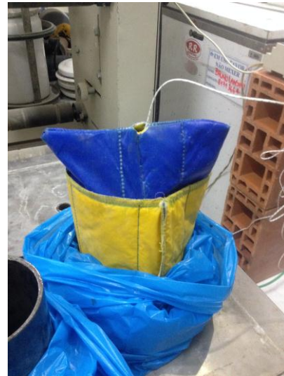
Figura 27 – Corpo de prova com manta e termopar posicionado
