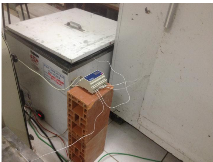
Figura 28 – Ensaio da medição da temperatura interna
