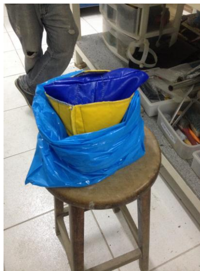
Figura 17 – Corpo de prova envolvido pela manta térmica
