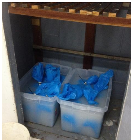
Figura 22 – Corpos de prova envoltos e fechados em sacos plásticos posicionados em caixas plásticas no interior da geladeira com temperatura controlada = 5°C
