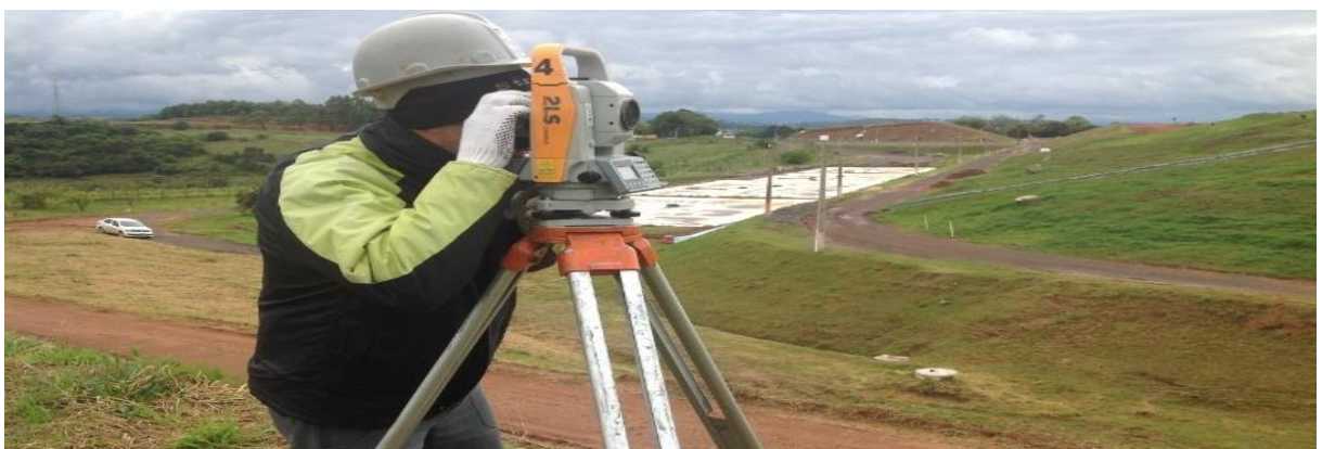
Figura 5.14 – Instalação do taqueômetro no tripé para medição das cotas
