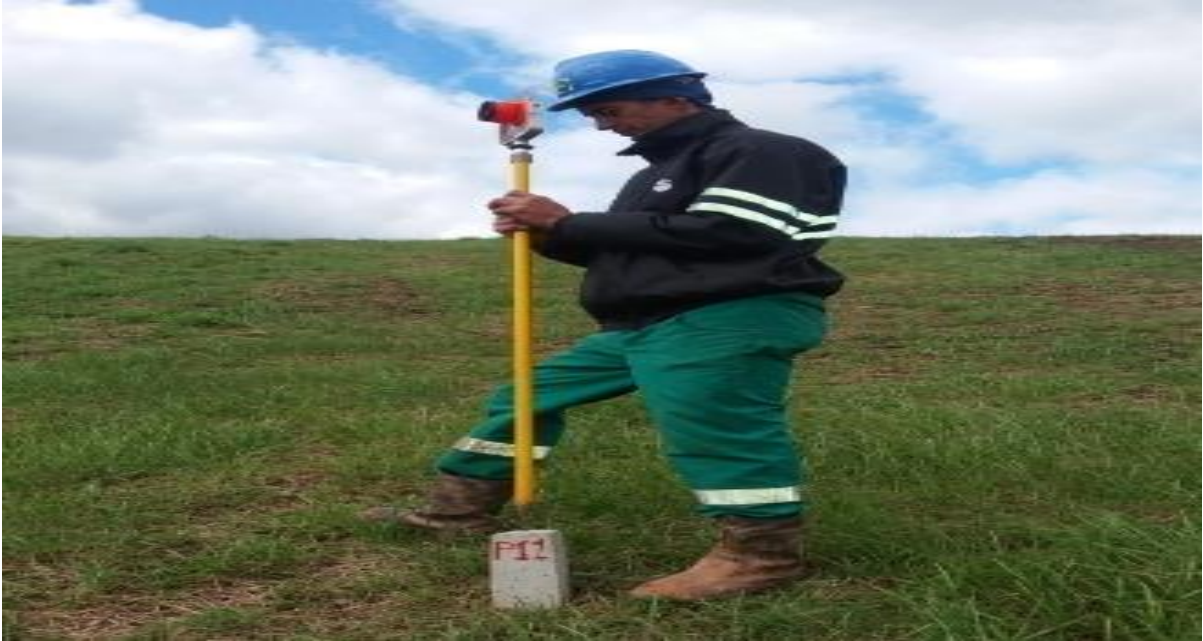
Figura 5.15 – Medição de cota no ponto desejado com auxílio de um operário
