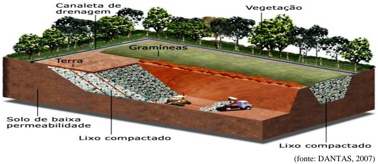
Figura 3.3 – Construção do aterro em rampa
