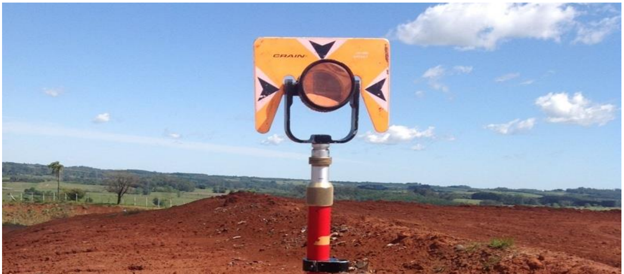
Figura 5.13 – Prisma para reflexão do sinal emitido pelo taqueômetro
