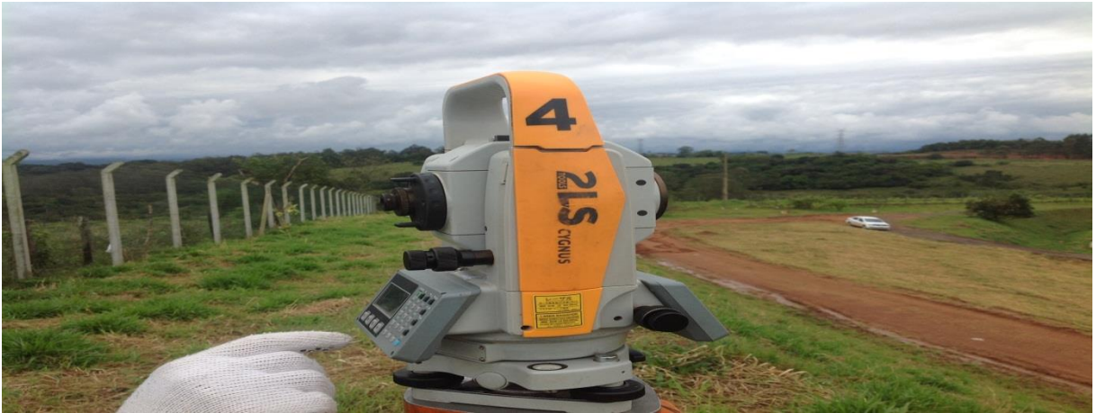
Figura 5.12 – Taqueômetro utilizado na coleta de dados em campo
