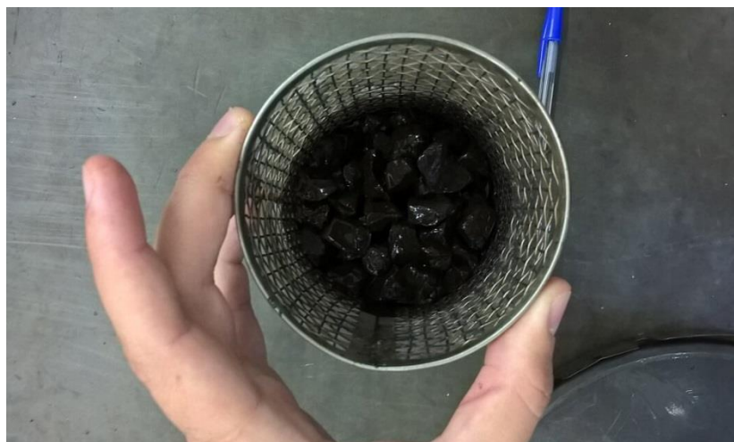
Figura 52 – Formação da película de emulsão sobre o agregado
