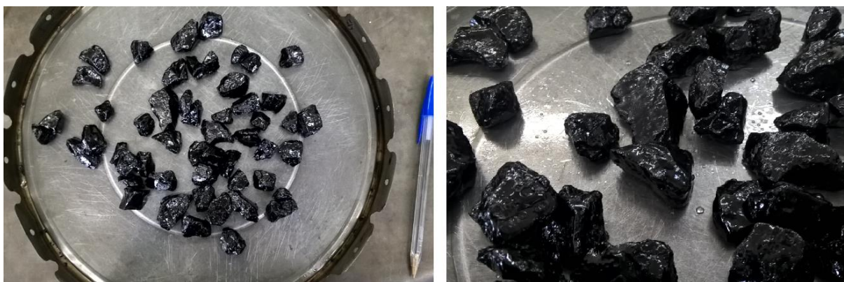
Figura 58 – Aspecto visual da adesividade da amostra D ao agregado de basalto
