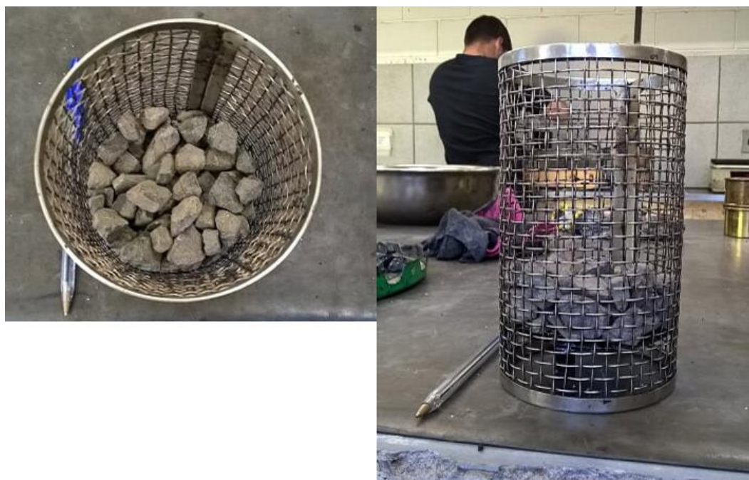
Figura 50 – Vista lateral e superior do cesto e agregado umedecido
