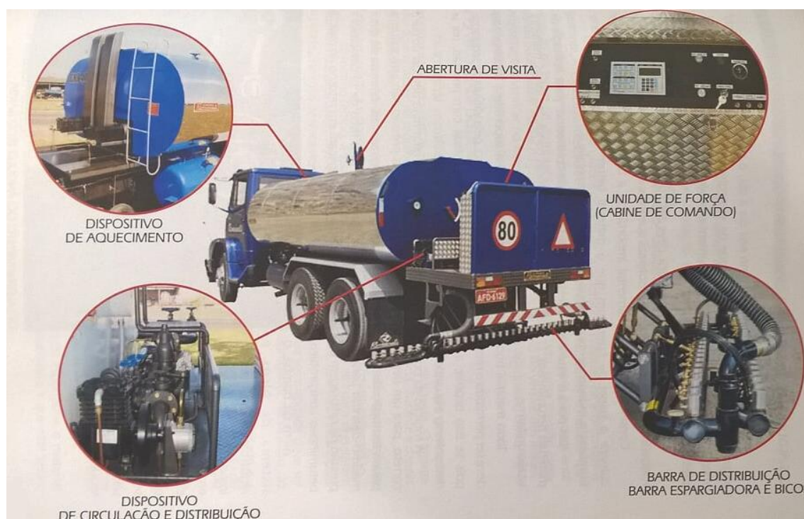
Figura 15 – Elementos principais de um veículo espargidor completo
