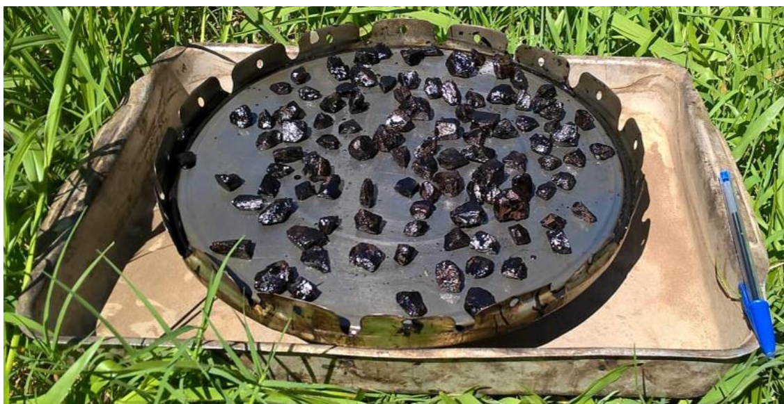
Figura 53 – Ruptura da película de emulsão RR-2C
