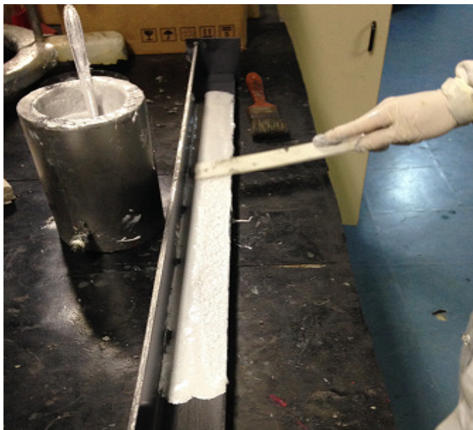
Figura 11 – Procedimento de aplicação da tinta B nos corpos de prova
