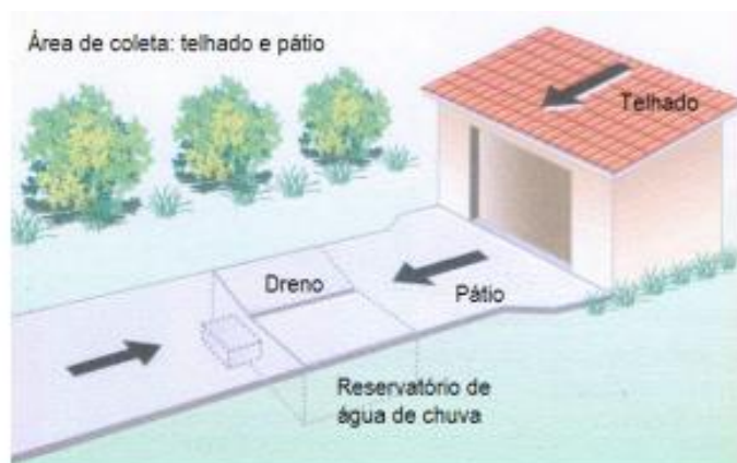
Figura 11 – Área de captação – telhado e pátio: armazenamento em reservatório subterrâneo
