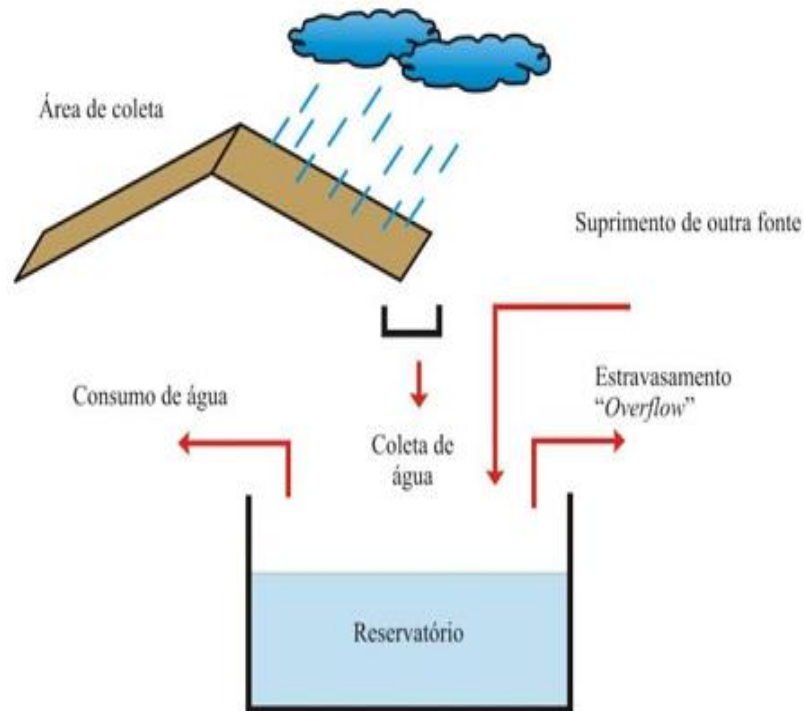
Figura 7 – Esquemática de um sistema de aproveitamento de água de chuva e seus fluxos de água
