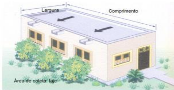
Figura 10 – Área de captação – laje: comprimento x largura
