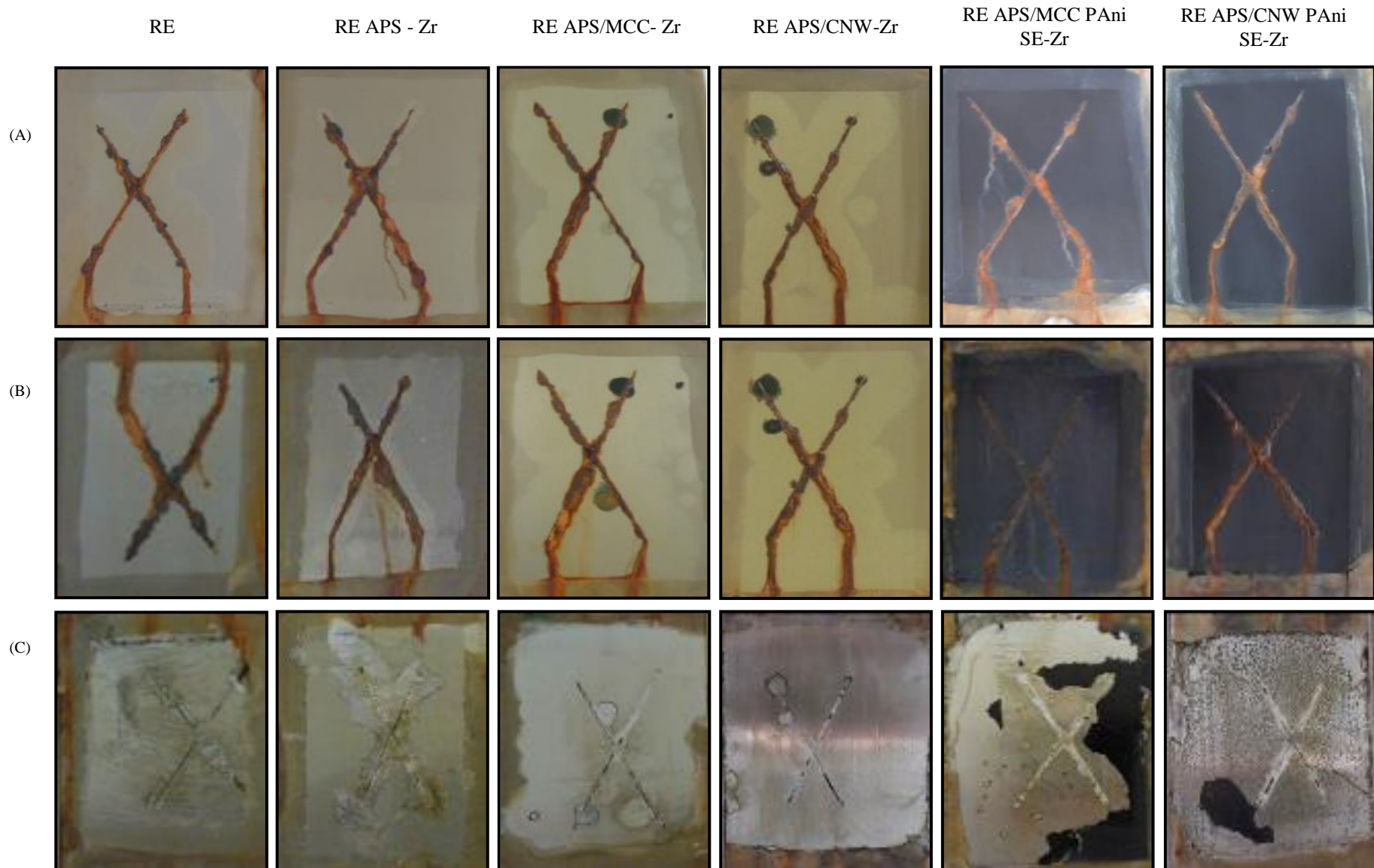
Figura 31 - Aspecto dos revestimentos poliméricos após (a) 500, (b) 1000 h de exposição à névoa salina e (c) aspecto após o descolamento do revestimento na análise da migração subcutânea após 1000 h de exposição à névoa salina
