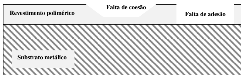
Figura 11 - Esquema da falta de coesão e adesão de um revestimento polimérico após o teste de aderência
