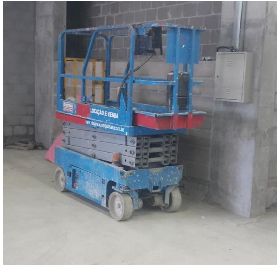
Figura 25–Plataforma de trabalho aéreo
