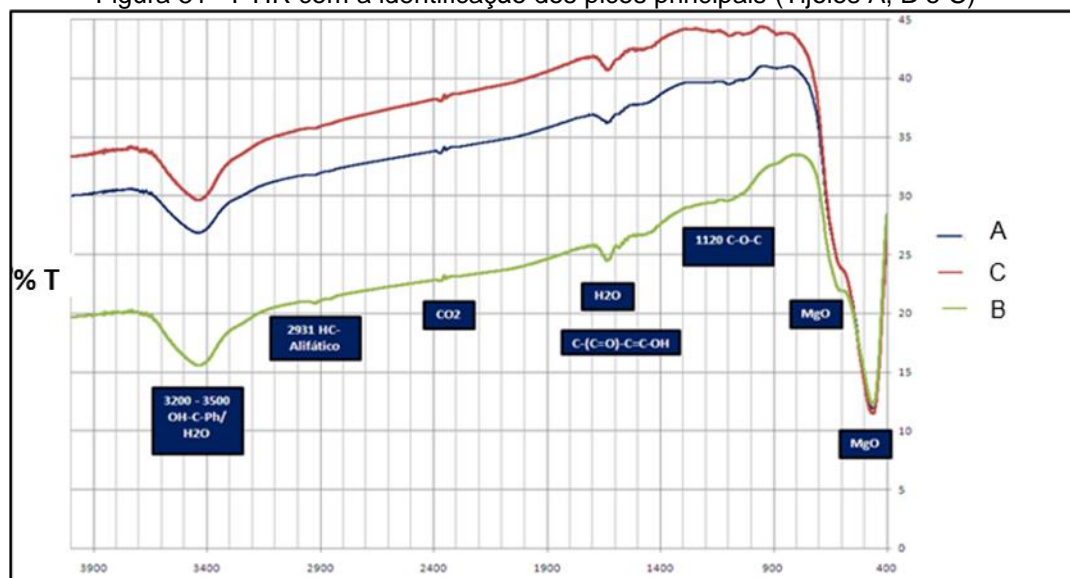
Figura 51 - FTIR com a identificação dos picos principais (Tijolos A, B e C)
