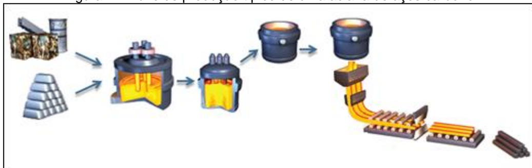
Figura 2 - Fluxo de produção típico de uma aciaria de aços carbono
