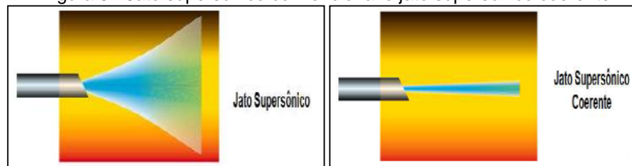
Figura 5 - Jato supersônico convencional e jato supersônico coerente
