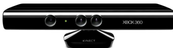
Figura 34 – Sensor de detecção de movimento para Xbox 360 da Microsoft. Kinect.
