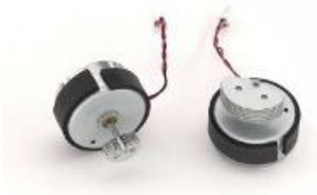
Figura 66 – Motores de vibração do controle Xbox 360.
