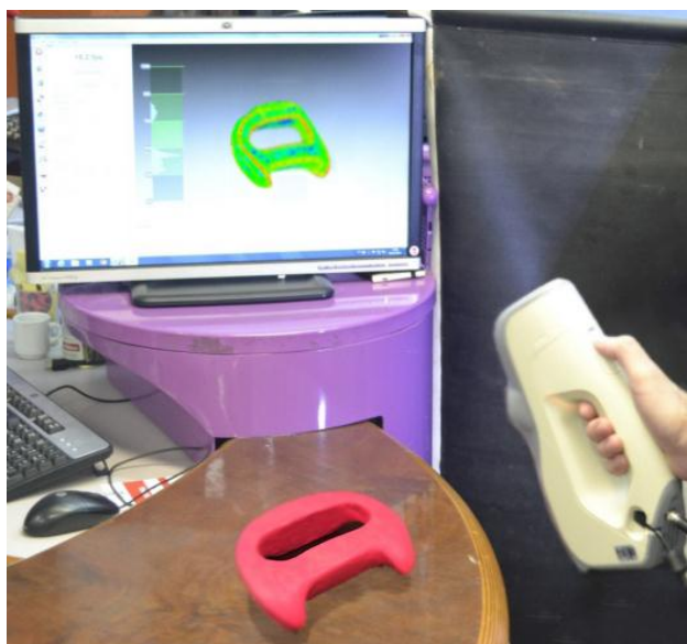
Figura 68 – Digitalização do modelo com o Artec Eva 3D.
