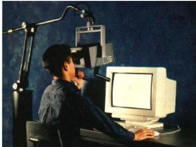
Figura 9 – O sistema BOOM utilizado com um computador.
