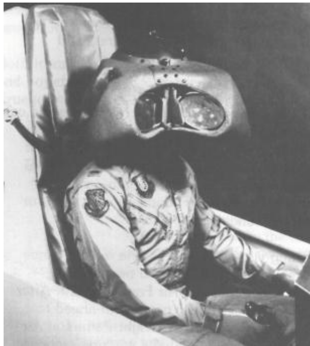
Figura 5 - Piloto usando o capacete do projeto Super Cockpit .
