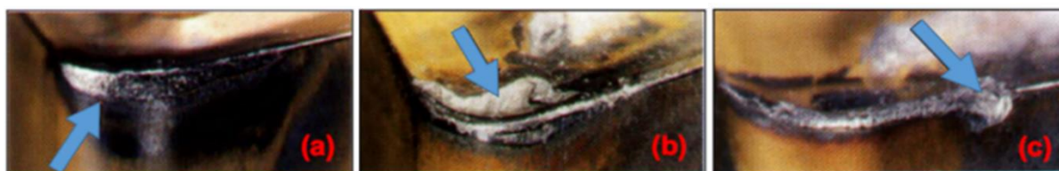
Figura 3.2 - Desgaste de ferramenta de corte. (a) Desgaste de flanco, (b) desgaste de cratera e (c) desgaste de entalhe [adaptada de UFRJ, 2014].
