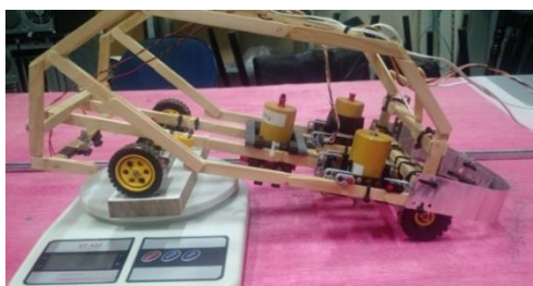
Figura 4.6 – Método para medição e calibração da altura do centro de massa (vide Anexo I).
