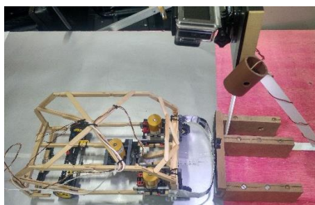
Figura 4.12 – Posicionamento da barreira para a colisão frontal total
