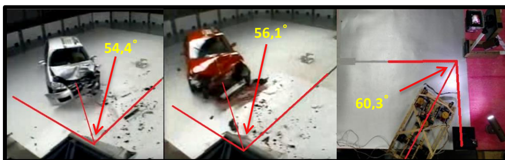
Figura 5.6 - Posição final do veículo em escala e de veículos reais similares, após o impacto.
